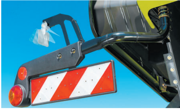
Рис. 5.15. Датчик контролю бічного вітру системи автоматичного регулювання напрямку розкидання подрібненої маси
