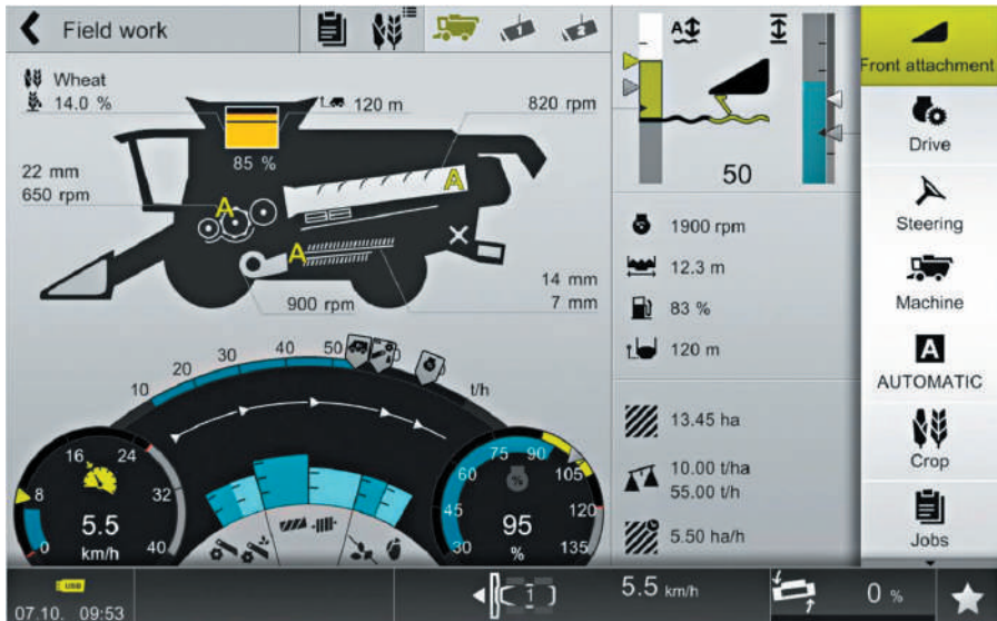
Рис. 9.10. Термінал «CEBIS Mobile» системи CEMOS оптимізації роботи комбайна
