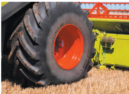
Рис. 7.12. Збільшення діаметра, ширини шини та зниження тиску в ній збільшує опорну поверхню (пляму контакту шини з опорною поверхнею)
