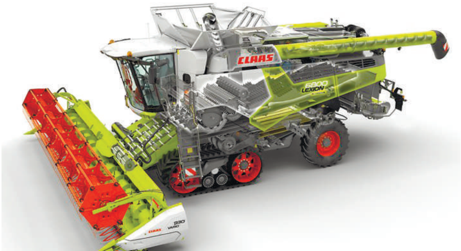
Рис. 10.1. Зернозбиральний клавішний комбайн «Claas» серії «Lexion 6800–6700»
