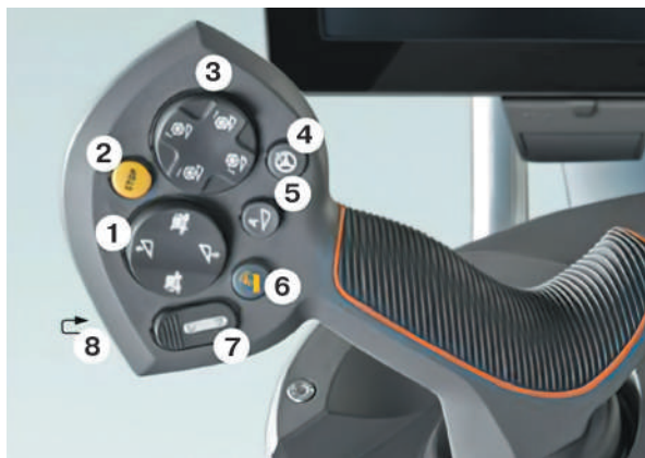
Рис. 2.12. Керування положеннями автоматичної системи управління жаткою комбайна «Fendt C»:
