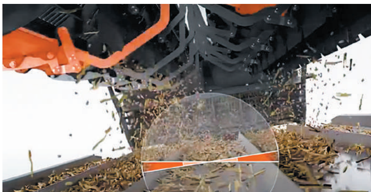
Рис. 10.9. Система сепарації зерна «Roto Plus»
