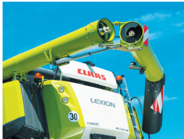
Рис. 4.37. Зменшення габаритних розмірів комбайна «Claas» при транспортних переїздах шляхом подвійного складання вивантажувального шнека
