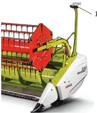
Рис. 2.15. Розміщення датчиків (1) системи «Laser Pilot» на жатці комбайна
