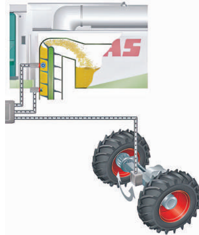
Рис. 4.29. Зерновий елеватор із датчиками врожайності та вологості зерна:
