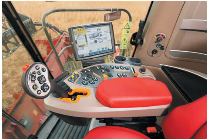
Рис. 10.33. Консоль керування комбайном «Axial-Flow 250»
