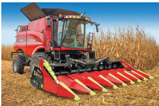
Рис. 2.64. Зернозбиральний комбайн із жаткою для збирання кукурудзи
