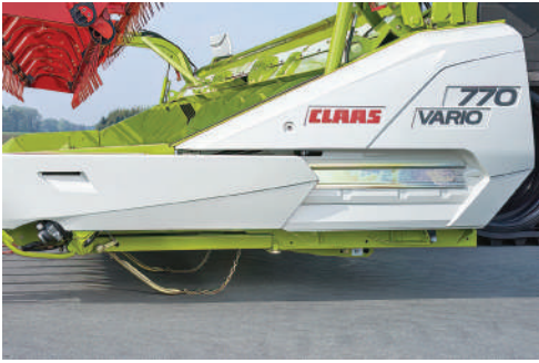
Рис. 2.8. Скоби-копіри під жаткою, що виконують функції механічних датчиків
