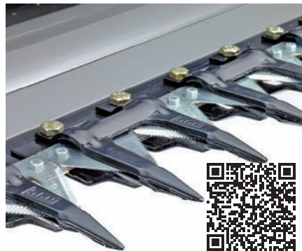
Рис. 2.33. Різальний апарат системи Шумахер
