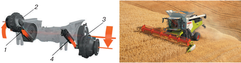
Рис. 7.5. Поворот бортових редукторів ведучого моста для поперечного вирівнювання комбайна та його положення на поперечному схилі:
