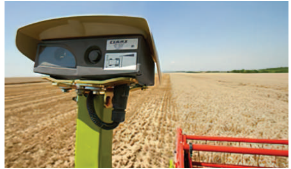
Рис. 2.15. Розміщення датчиків (1) системи «Laser Pilot» на жатці комбайна
