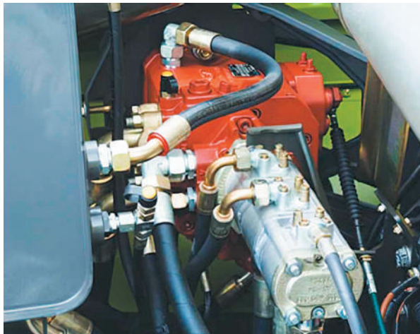
Рис. 8.7. Розміщення насосів гідравлічного приводу на комбайні «Claas»
