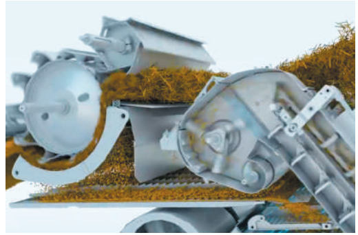
Рис. 3.4. Молотильний апарат і технологія обмолочування та сепарації:
