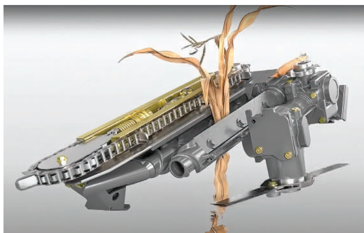
Рис. 2.73. Технологічний процес відривання качана лінійними вальцями та горизонтального подрібнення стебел кукурудзи
