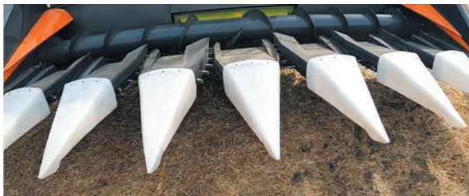
Рис. 2.78. Жатка «Optiger» з ліфтерами, транспортерами стебел і вібростолом
