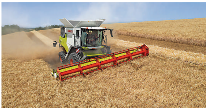
Рис. 4.21. Поперечне вирівнювання корпусу комбайна «Claas» на схилі
