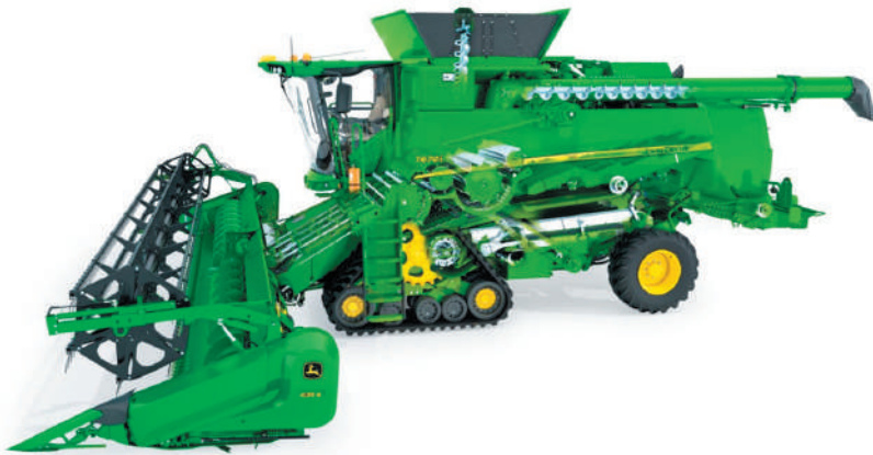
Рис. 10.11. Зернозбиральний клавішний комбайн «John Deere» серії Т
