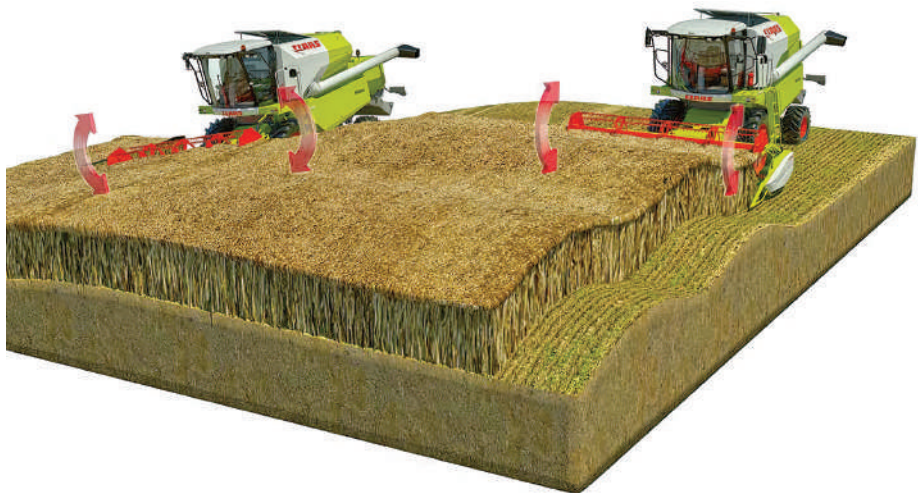
Рис. 2.9. Робота на нерівному полі комбайнів, оснащених системами «Claas Contour» та «Auto Contour»
