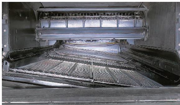
Рис. 4.15. Компенсація бічного нахилу комбайна «New Holland» поворотом секцій решет
