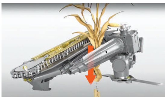
Рис. 2.74. У конічних качано-відривних вальцях швидкість протягування кукурудзи зростає при переміщенні її на більший діаметр вальців
