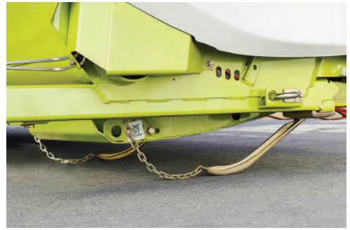
Рис. 2.8. Скоби-копіри під жаткою, що виконують функції механічних датчиків
