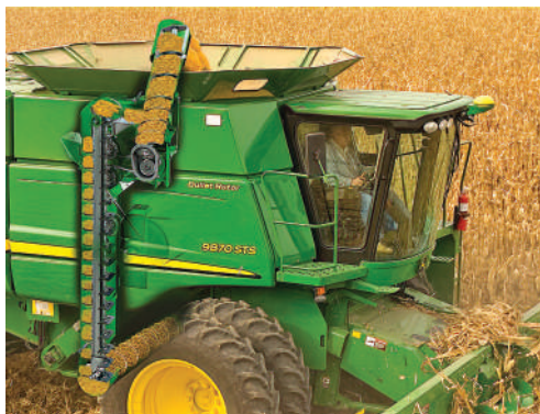
Рис. 4.27. Транспортні пристрої подання зерна в бункер комбайна «John Deere» моделі 9870 STS
