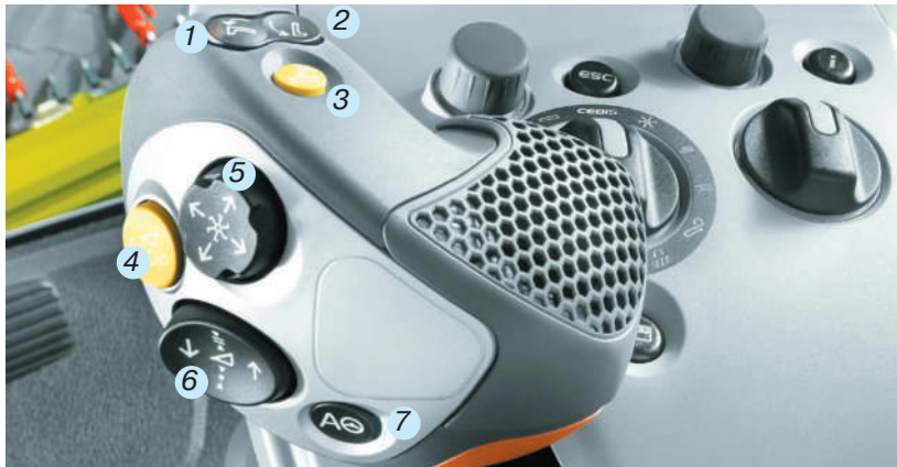
Рис. 9.4. Багатофункціональний важіль SMOTION для комфортного керування комбайном:
