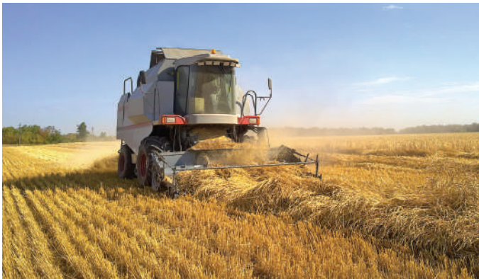
Рис. 1.3. Друга фаза двофазної технології — підбирання та обмолочування валків
