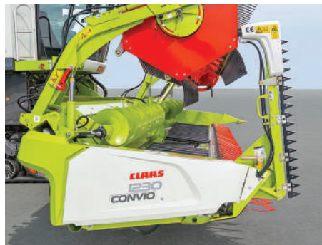
Рис. 2.18. Активний бічний подільник жатки
