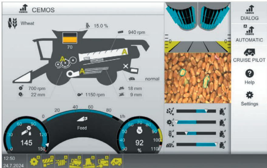
Рис. 9.11. Оцінювання якості зерна за допомогою терміналу «CEBIS Mobile»
