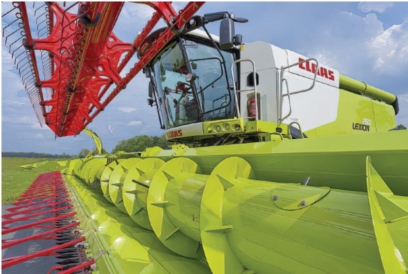
Рис. 2.48. Поріжок на днищі жатки для безперебійного подання хлібної маси з різального апарата до шнека
