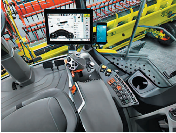
Рис. 10.7. Схема розміщення органів керування на зернозбиральних комбайнах серії «Claas Trion 700»
