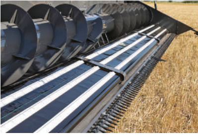
Рис. 2.51. Жатка «PF Massey Ferguson» із подовжнім транспортером між різальним апаратом і шнеком
