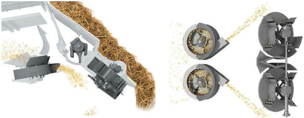
Рис. 5.14. Установлення роторного розкидача в режим укладання соломи у валки
