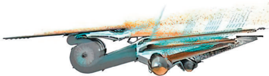
Рис. 10.4. Системи «Jet Stream» і «Dynamic Cooling» зернозбиральних комбайнів «Claas Lexion 6800–6700»
