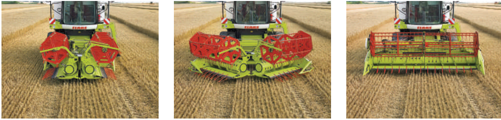
Рис. 2.56. Складна жатка. Завдяки компактній конструкції в складеному положенні забезпечується оптимальний огляд і хороша маневреність під час переїздів навіть в обмеженому просторі
