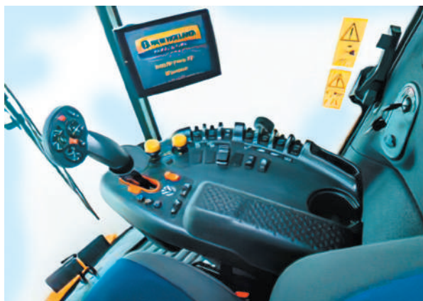
Рис. 10.18. Розміщення консолі керування в кабіні комбайна «New Holland CH 7.70»
