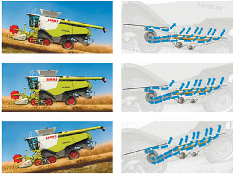
Рис. 4.16. Автоматичне регулювання потоку повітря від вентилятора під час руху комбайна на схилах
