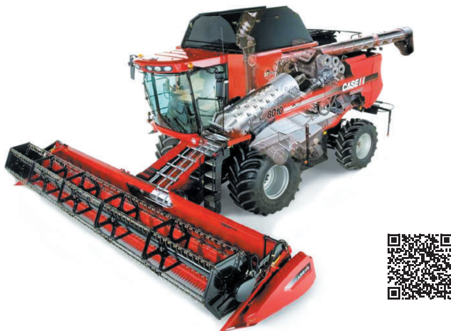
Рис. 10.29. Розміщення агрегатів на комбайнах «Case IH» серії «Axial-Flow»
