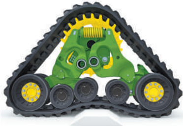
Рис. 7.16. Копіювання рельєфу трикутною гусеницею комбайнів «John Deere»
