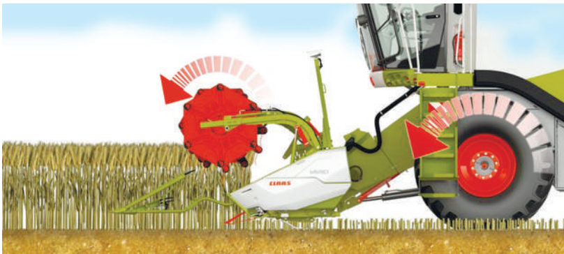
Рис. 2.25. Правильне положення планок мотовила відносно колосків
