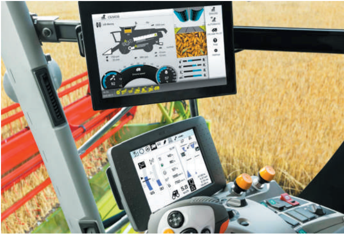
Рис. 9.9. Термінал «SEBIS Mobile» та система управління SEBIS комбайнів «Lexion 600/700 Hybrid»
