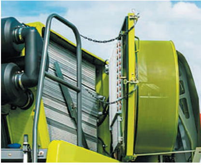
Рис. 6.13. Установлення радіаторів на комбайні
