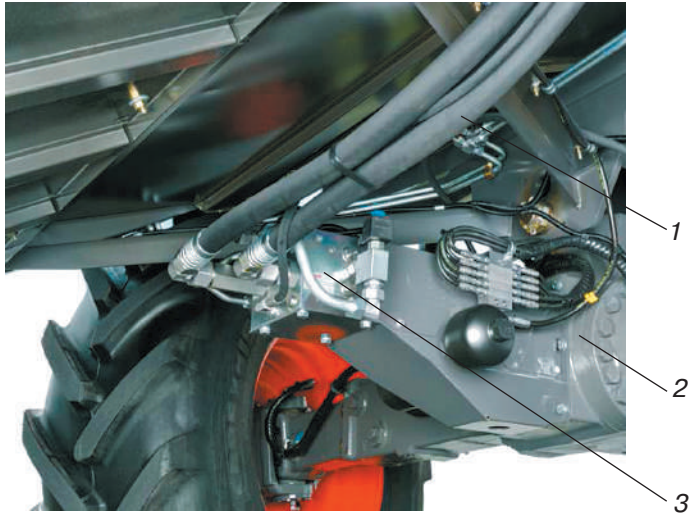
Рис. 8.6. Гідравлічний привід моста напрямних коліс:
