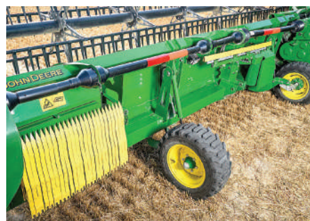
Рис. 2.13. Опорні колеса, установлені на жатці для поліпшення копіювання рельєфу ґрунту
