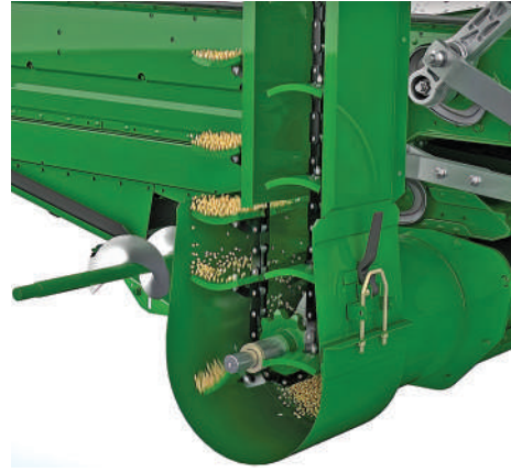
Рис. 4.28. Зерновий шнек і нижня частина елеватора комбайна «John Deere»
