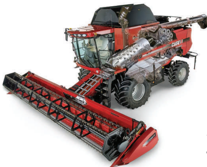
Рис. 1.4. Зернозбиральний комбайн із молотильно-сепарувальним пристроєм класичної схеми обмолоту
