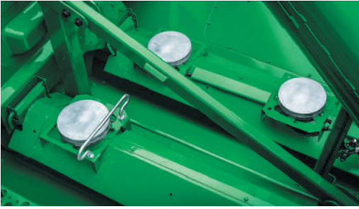
Рис. 4.35. Тензодатчики для визначення маси намолоченого зерна в зерновому бункері комбайна «John Deere» серії S
