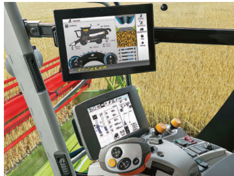
Рис. 2.22. Багатофункціональний джойстик і монітор SEBIS комбайна «Claas»
