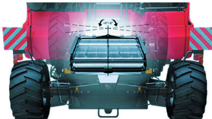
Рис. 10.32. Самовирівнювана система очищення
