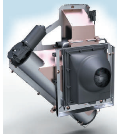
Рис. 4.32. Камера якості зерна комбайна «Axial-Flow®» серії 250
