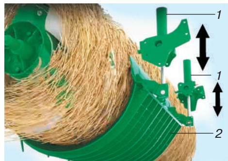
Рис. 3.19. Регулювання зазору між ротором і підбарабанням за допомогою гідроциліндрів:
