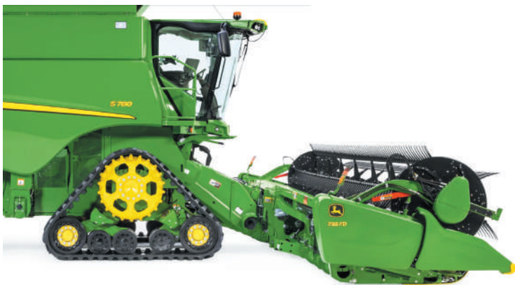
Рис. 7.15. Трикутна конструкція гусениць комбайна «John Deere»
