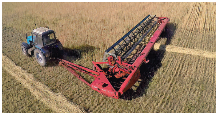
Рис. 1.2. Перша фаза двофазної технології — зрізання та вкладання у валки хлібної маси валковими жатками
