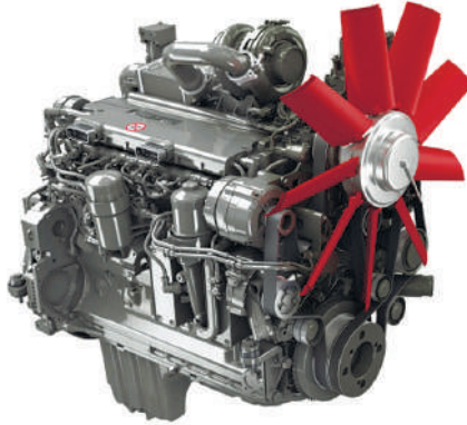
Рис. 10.28. Реверсивний вентилятор двигуна, що автоматично змінює напрямок потоку повітря, ефективно очищує елементи радіатора
