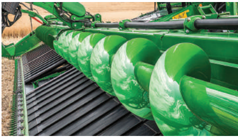
Рис. 2.52. Жатка «John Deere» серії 700D із додатковими поперечними стрічковими транспортерами, що мають високі ребра
