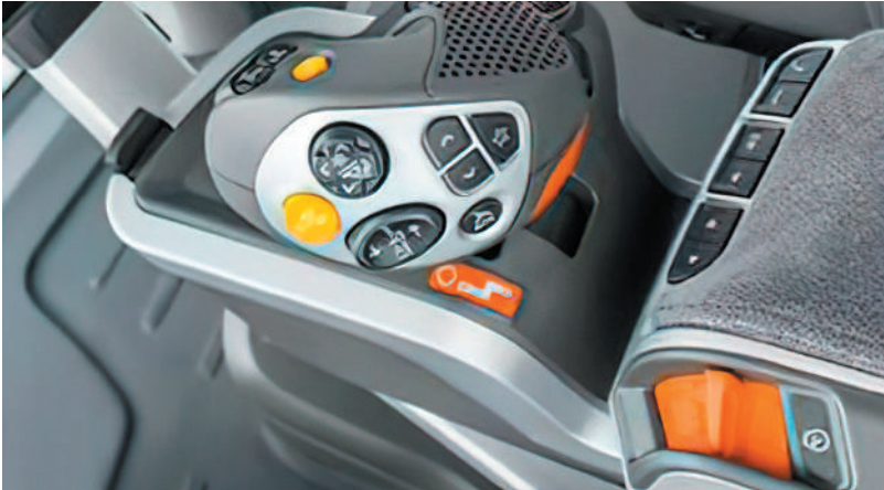
Рис. 10.5. Багатофункціональний підлокітник і джойстик керування комбайном
