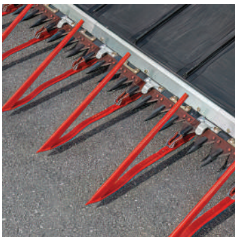
Рис. 2.39. Установлення стеблопідіймачів на різальному апараті
