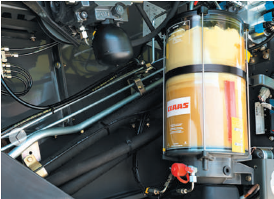
Рис. 8.10. Система централізованого змащування
