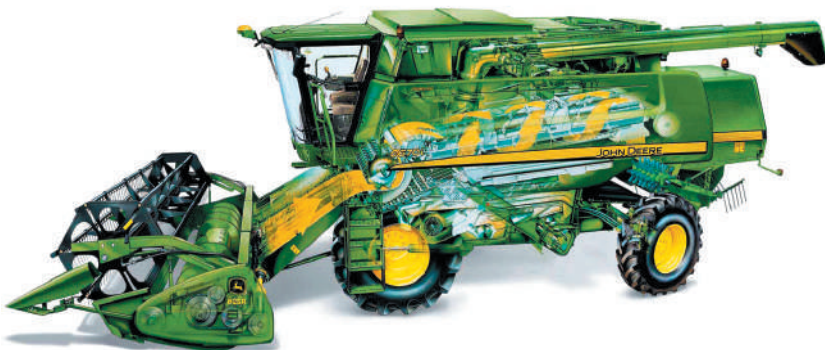
Рис. 10.10. Зернозбиральний клавійний комбайн «John Deere» серії W
