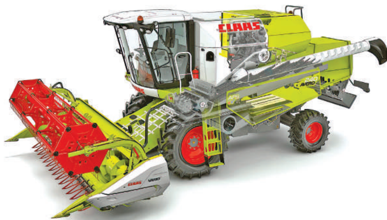
Рис. 1.4. Зернозбиральний комбайн із молотильно-сепарувальним пристроєм класичної схеми обмолоту
