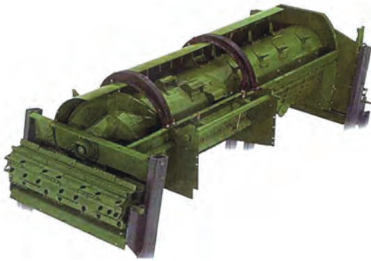
Рис. 6.51. Роторний молотильно-сепарувальний пристрій комбайна John Deere S770
