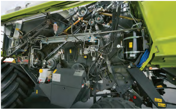
Рис. 6.40. Зручний доступ до двигуна скорочує час його обслуговування
