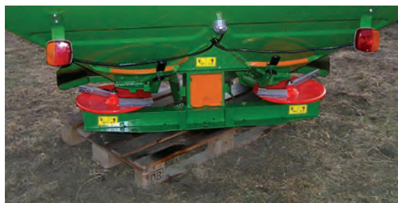
Рис. 3.5. Диски розкидачів відомих виробників мають збільшений строк експлуатації
