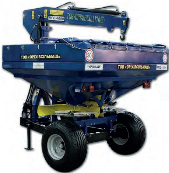
Рис. 3.4. Розкидач мінеральних добрив РМД-3000 зі стаціонарним гідравлічним маніпулятором МГС-1000
