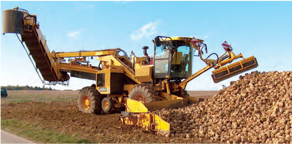
Рис. 8.45. Очищення та перевантаження цукрових буряків самохідним навантажувачем-доочищувачем RL 200SF
