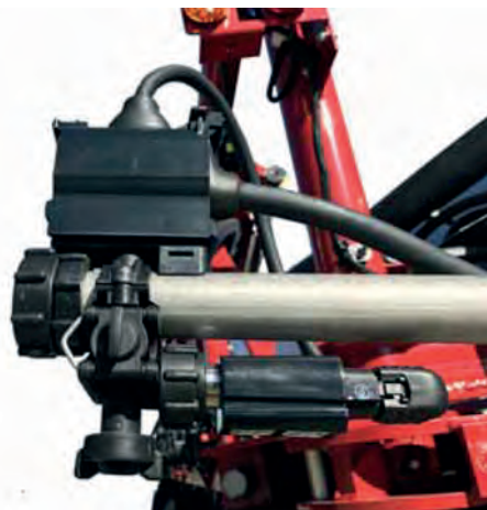
Рис. 4.12. Система автоматичного водіння AFS AccuGuide (а) і система обприскування AIM Command (б) обприскувача Case IH Patriot
