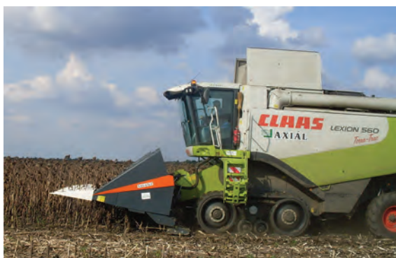
Рис. 6.28. Соняшникова жатка з вмонтованим подрібнювачем стебел Optiger OptiSun 676Z
