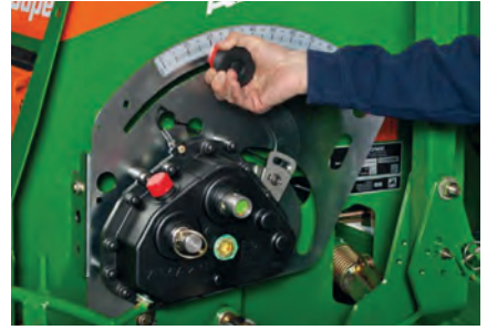
Рис. 2.14. Керування нормою висіву за допомогою редуктора Vario
