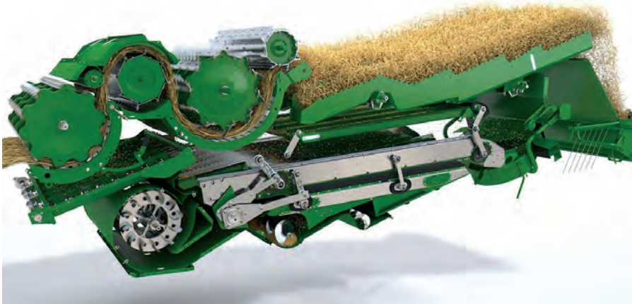
Рис. 6.47. Система обмолоту й очищення зерна в комбайнах John Deere серії Т
