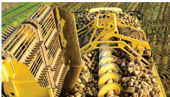
Рис. 8.42. Об'єм бункера комбайна Rora Euro Tiger V8-4 понад 40 м 3
