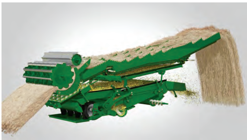
Рис. 6.5. Класична система обмолоту зернозбирального комбайна
