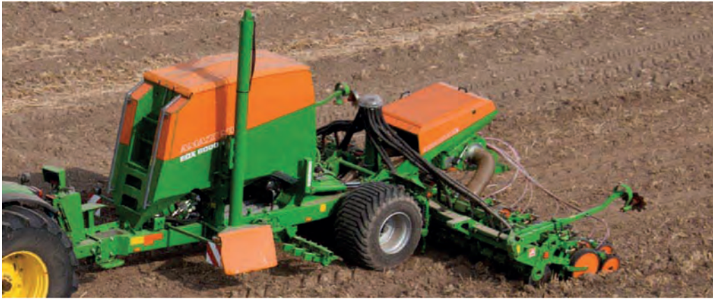
Рис. 2.29. Просапна сівалка Amazone EDX 6000-ТС із пневматичними висівними апаратами
