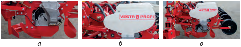
Рис. 2.32. Висівний апарат Profi (а), довговічні пластикові бункери (б) і високоточна висівна секція (в) сівалки Vesta 8 Profi
