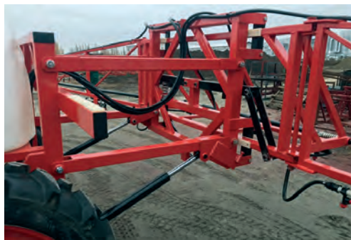
Рис. 4.15. Штанговий робочий орган (а) і система його підвіски та стабілізації (б)
