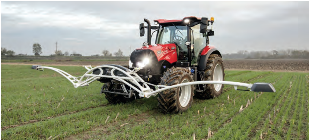
Рис. 3.9. N-сенсор для визначення вмісту азоту в рослинах
