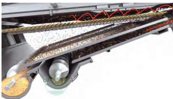
Рис. 6.39. Удосконалена система очищення комбайна Claas Tucano
