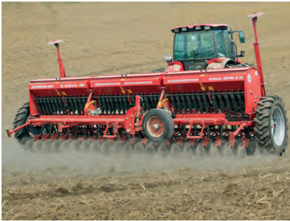
Рис. 2.7. Сівалка «Ельворті» Astra 6 (а) і висівний механізм (б)
