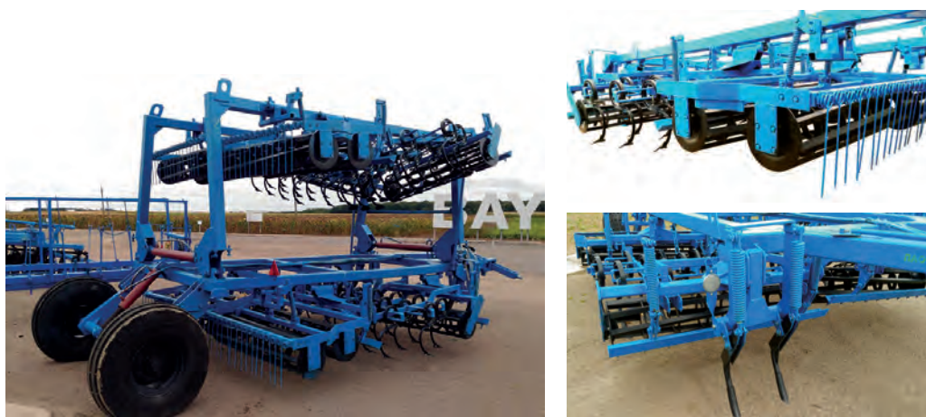
Рис. 1.27. Комбіновані напівначіпні агрегати типу «Європак» і їхні конструктивні особливості
