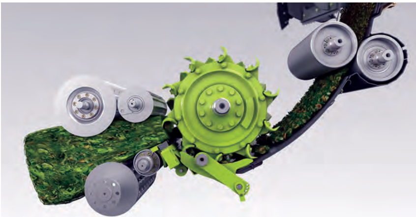
Рис. 5.23. Схема роботи комбайна Claas Jaguar
