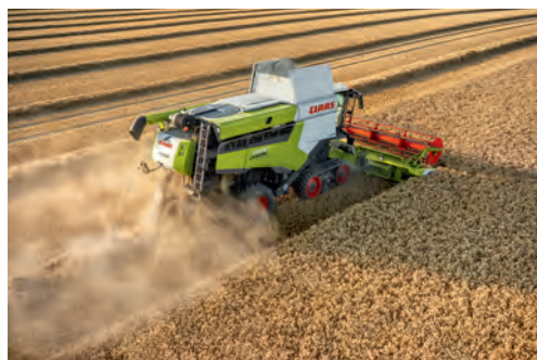
Рис. 6.6. Під час роботи зернозбирального комбайна солома подрібнюється та розкидається по полю (а) або укладається у валок (б)
