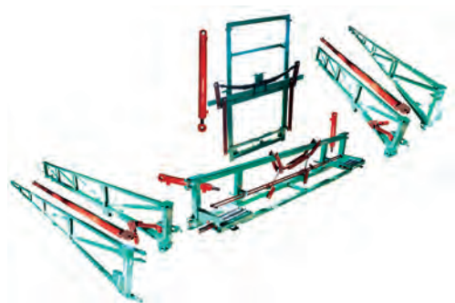
Рис. 4.15. Штанговий робочий орган (а) і система його підвіски та стабілізації (б)
