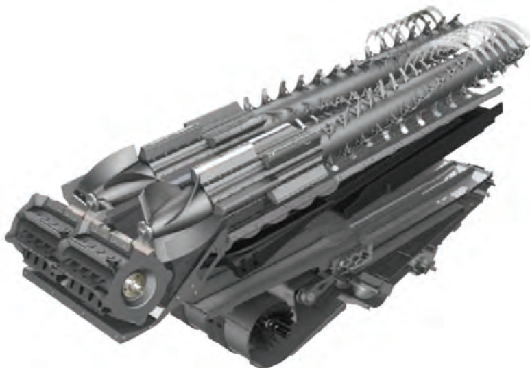
Рис. 6.62. Система обмолоту Dual Helix комбайнів Fendt Ideal
