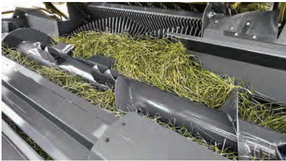
Рис. 5.10. Система PFS прес-підбирача Claas Quadrant
