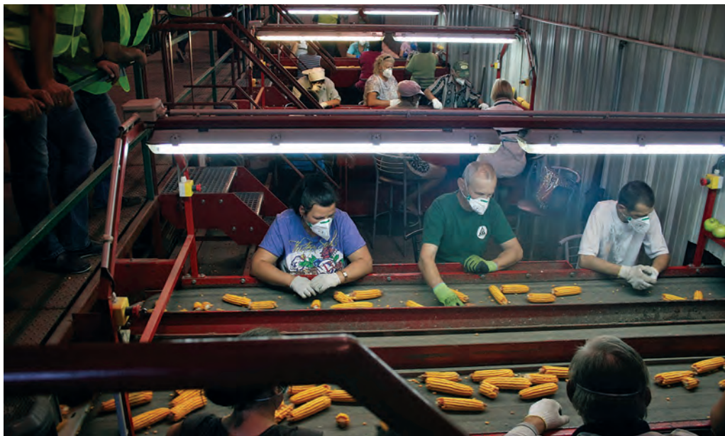
Рис. 7.19. Поточкова лінія очищення качанів на насінневому заводі
