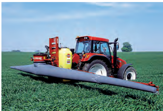
Рис. 4.18. Обприскувач Hardi MASTER Plus із системою примусового осадження крапель Twin Force
