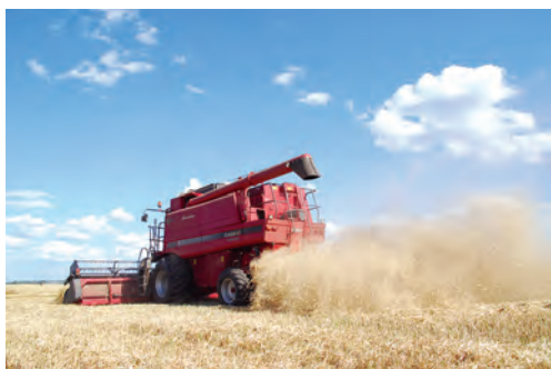
Рис. 6.6. Під час роботи зернозбирального комбайна солома подрібнюється та розкидається по полю (а) або укладається у валок (б)
