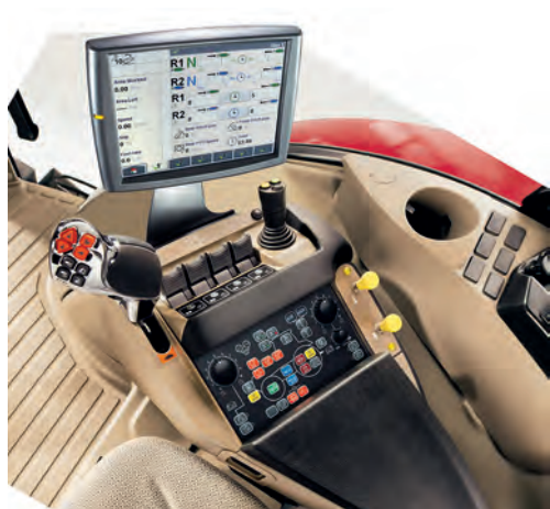
Рис. 4.12. Система автоматичного водіння AFS AccuGuide (а) і система обприскування AIM Command (б) обприскувача Case IH Patriot
