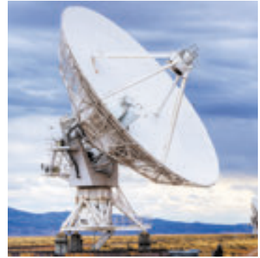
Fig. 21.3. Radiația fascicului direcționat îngust de radiunde ultracurte și receptarea semnalului reflectat este asigurată de antena parabolică a radiolocatorului
