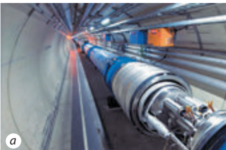
Fig. 22.1. Cea mai mare instalație de investigație la ora actuală – acceleratolul de particule încărcate, primul demaraj al căruia a avut loc în a. 2008: a – aspectul interior; b – reprezentarea schematică. Uimesc dimensiunile acestui acceleratol: particulele elementare își iau viteza într-un inel imens cu lungimea de 26 km. Țările din Europa au fost nevoite să-și îmbine eforturile sale pentru a construi acest miracol al tehnicii
