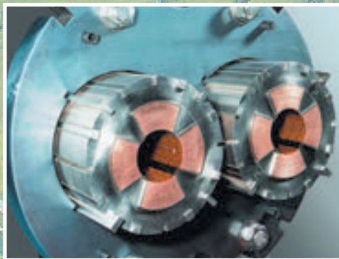
Fig. 2. Magneți supraputernici, care mențin particulele încărcate în interiorul acceleratorului
