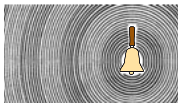
Fig. 17.4. Oscilațiile corpului, care emite sunet sunt cauza comprimărilor și rarefierilor mediului – prin mediu se propagă o undă sonoră
