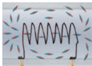
Fig. 3.4. Cercetarea câmpului magnetic produs de o bobină parcursă de curent cu ajutorul acelor magnetice
