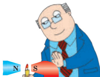
Fig. 5.3. Flacăra lumânării este împinsă din câmpul magnetic, deoarece produsele de ardere sunt particule diamagnetice
