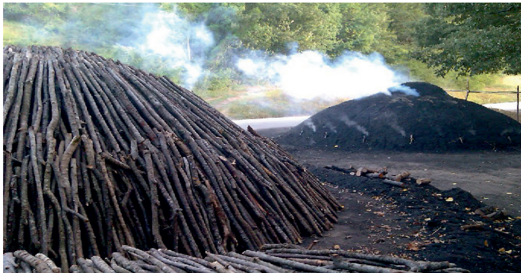
Мал. 38.7. Виготовлення деревного вугілля
