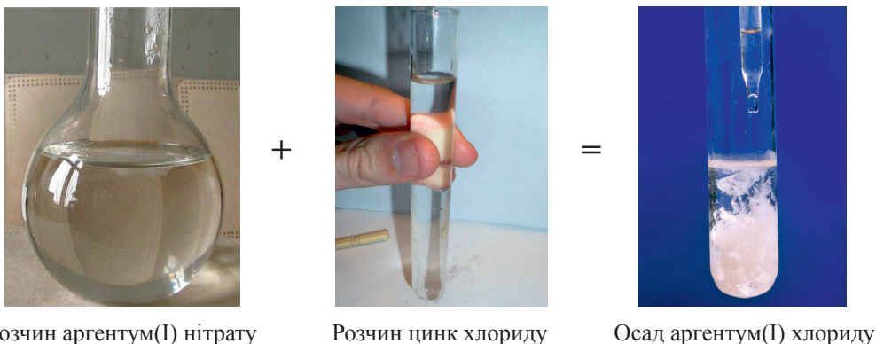
Рис. 12.2. Взаємодія розчину цинк хлориду з розчином аргентум(I) нітрату
