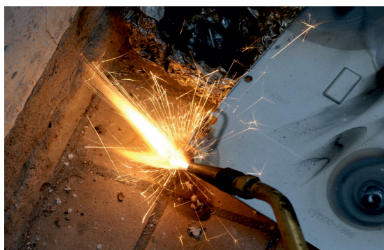
Рис. 27.4. Різання металу з використанням ацетиленового пальника
