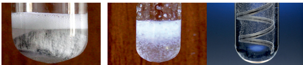
Рис. 21.1. Взаємодія магнію (а), цинку (б) й заліза (в) із хлоридною кислотою
