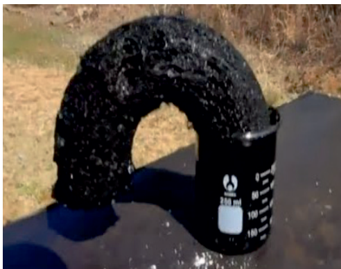
Рис. 37.4. Обвуглення сахарози під дією сульфатної кислоти
