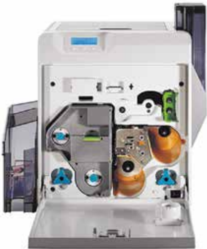
2.32. ábra. Szublimációs nyomtató és a hozzá tartozó színes fóliák készlete
