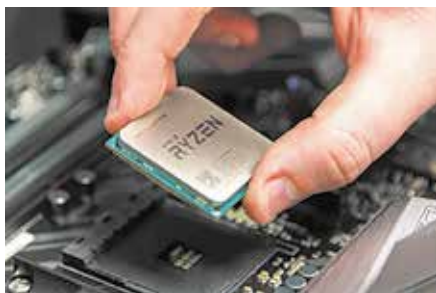
2.2. ábra. 8 magvas AMD Ryzen 7 processzor
