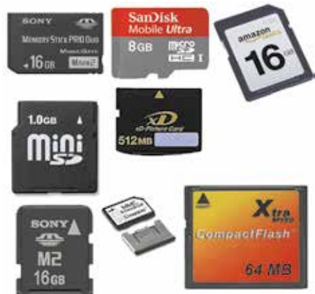
2.7. ábra. Különböző típusú flash-memóriák
