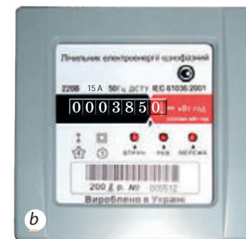
Fig. 33.1. Notarea indicațiilor contorului: a – datele inițiale (382 kW·h); b – datele contorului peste un anumit timp de lucru al încălzitorului electric (385 kW·h). Cantitatea energiei electrice consumate în acest timp: 385 – 382 = 3 (kW·h)
