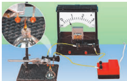
Fig. 36.3. Experiență, care demonstrează dependența rezistenței metalelor de temperatură. În procesul de încălzire a spiralei intensitatea curentului în ea se micșorează, deci rezistența spiralei crește
