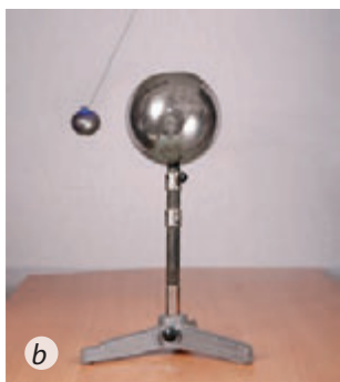
Fig. 21.3. Electrizarea sferei prin inducție (a); drept indice a prezenței sarcinii servește balonașul aerian încărcat pozitiv – el deviază de la sferă, deci, sfera (spre deosebire de bastonaș) este încărcată pozitiv (b)
