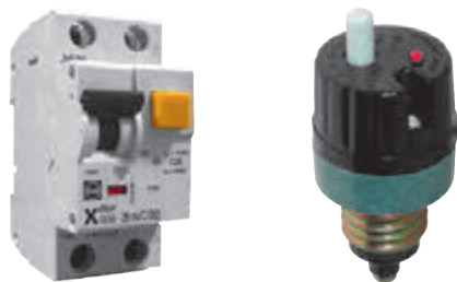
Fig. 35.5. Siguranțe automate. Partea de lucru a siguranței automate – o placă bimetalică. În cazul creșterii intensității curentului peste limita admisibilă placa bimetalică se încovoiește, ca urmare circuitul se întrerupe. După răcire siguranța poate fi din nou readusă în starea de lucru
