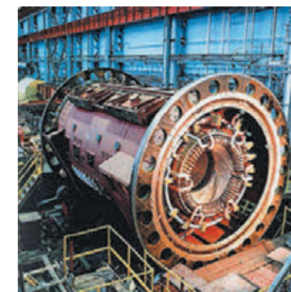
Fig. 25.2. Datorită turbogeneratoarelor, care transformă energia mecanică de rotație a turbinelor în energie a curentului electric, produc 80 % din energia electrică consumată în lume
