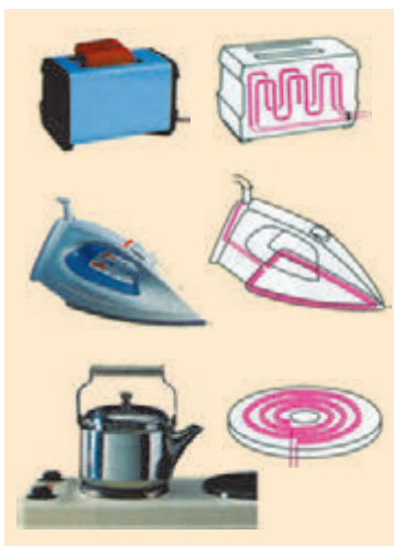
Fig. 35.2. Partea principală a oricărui dispozitiv electric de încălzit este elementul încălzitor
