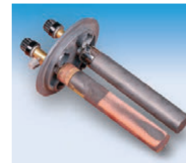
Fig. 37.5. Peste câteva minute de la începutul trecerii curentului prin soluția clorurii de cupru suprafața catodului se va acoperi cu un strat subțire de cupru
