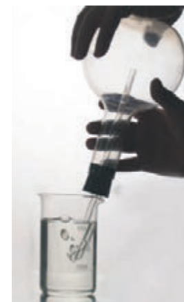
Fig. 2.1. Aerul în retortă, încălzindu-se se dilată și o anumită parte a lui iese din retortă – lângă gaura tubului se formează bule de aer
