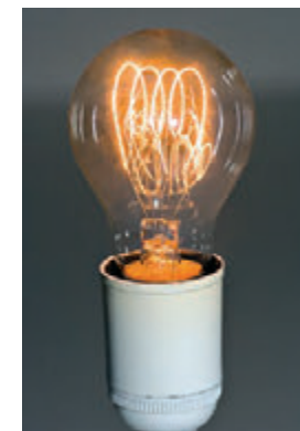
Fig. 35.3. Elementul încălzitor al becului electric cu incandescență este confecționat din wolfram, temperatura de topire a căruia este de 3387°C. Încălzindu-se până la temperatura de 3000°C, firul subțire de wolfram începe să lumineze strălucitor
