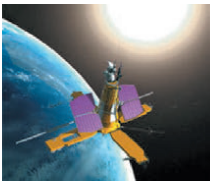
Fig. 25.3. Bateriile solare ale satelitului de sondare la distanță a Pământului furnizează energie electrică pentru toată aparatura de cercetare. Bateriile solare transformă energia luminii în energie electrică
