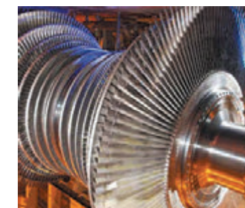
Fig. 17.3. În turbinele moderne pentru utilizarea maximă a energiei aburului se folosesc câteva discuri cu paletete, care sunt fixate pe un arbore comun
