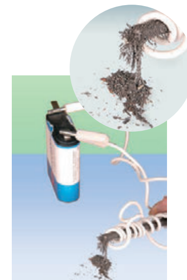
Fig. 24.5. În timpul trecerii curentului cuiul devine magnet și atrage spre sine pilitura de fier
