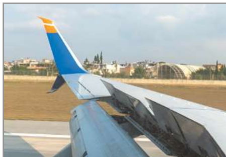
Рис. 33.3. Гідравлічні пристрої допомагають «розкрити» крила сучасного літака та сприяють швидшому гальмуванню під час посадки
