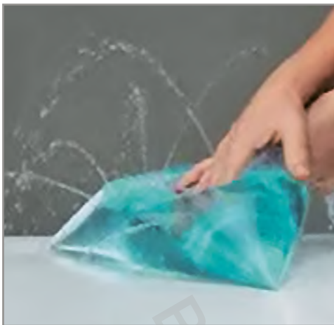
Рис. 29.5. Вода передає додатковий тиск у всі боки, і саме тому вода виходить із отворів у пакеті в усіх напрямках
