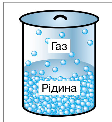
Рис. 17.3. Відстань між молекулами газу набагато більша, ніж відстань між молекулами рідини
