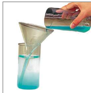
Рис. 5.1. За допомогою лійки можна акуратно налити розчин мідного купоросу на дно склянки з водою
