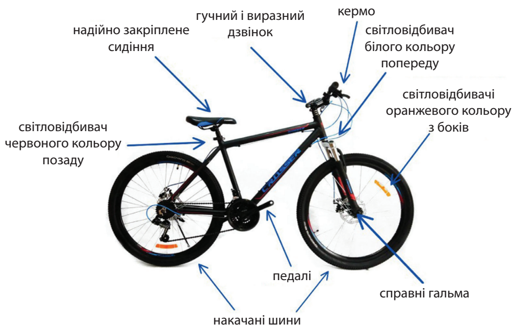
Рис. 81. Елементи конструкції велосипеда, що впливають на безпеку руху
