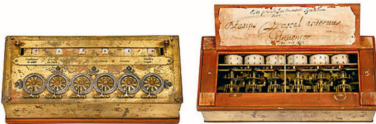
Механічна машина Блеза Паскаля для знаходження суми та різниці чисел
