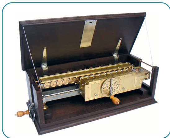
Арифмометр Готфріда Лейбніца для знаходження суми, різниці, добутку та частки чисел
