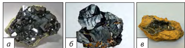
Мал. 2. Залізні руди: а) магнетит, магнітний залізняк; б) гематит, червоний залізняк; в) лімоніт, бурий залізняк.
