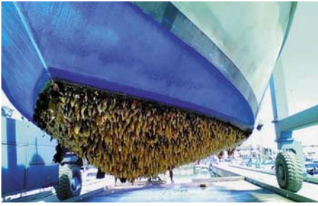
Мал. 15.4. Обростання водоростями та іншими організмами дна кораблів знижує швидкість їхнього пересування та збільшує витрати пального
