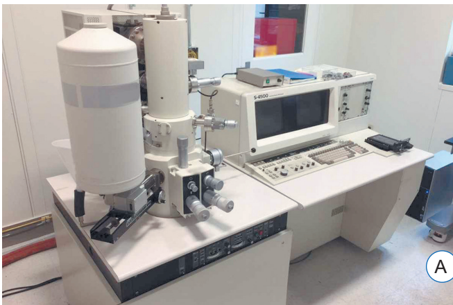
4.4. ábra. A – modern elektronmikroszkóp. B – Bacillus subtilis baktérium sejtje (magyarul szénabacillus), a felvétel elektronmikroszkóppal készült 73000-szeres nagyítással
