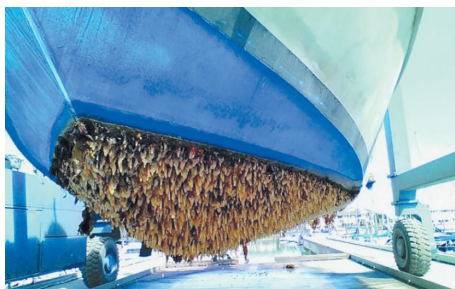
15.4. ábra. A hajók fenekét benövő moszatok és egyéb szervezetek csökkentik a hajók sebességét és növelik az üzemanyag fogyasztását
