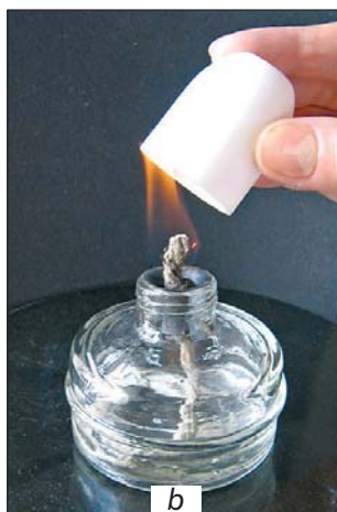
15. Ábra. Szeszégő (a) és láng oltása kupakkal (b)
