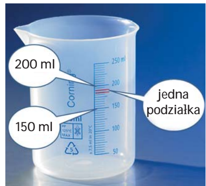
Rys. 5.2. Określanie wartości podziałki skali menzurki
