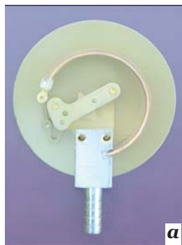
Rys. 23.6. Budowa manometru metalowego
