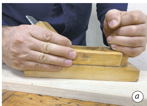
Rys. 6.5. Położenie rąk w czasie pracy drewnianym (a) i metalowym strugiem (b)
