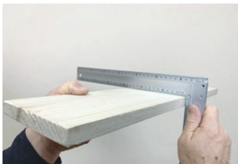
Rys. 6.9. Sprawdzanie heblowanej płaszczyzny linijką i kątownikiem
