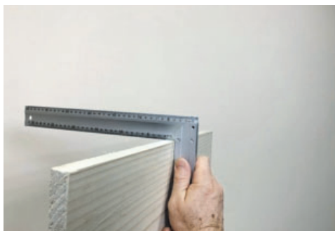
Rys. 6.10. Sprawdzanie prostokątności krawędzi
