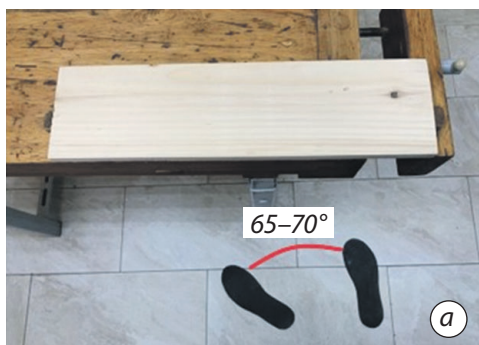
Rys. 6.6. Położenie nóg przy struganiu warstwy (a) i krawędzi (b)
