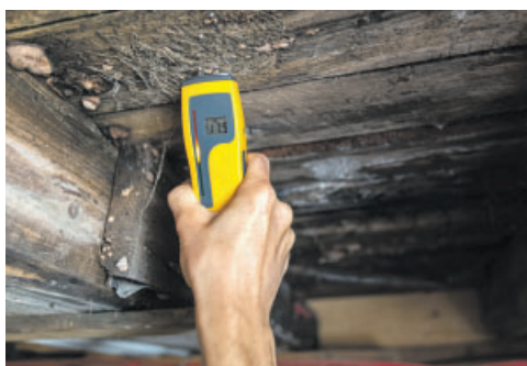
Rys. 4.3. Wymierzanie wilgotności z pomocą wilgotnościomierza
