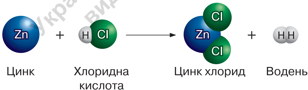
Мал. 46. Модель схеми хімічної реакції цинку з хлоридною кислотою
