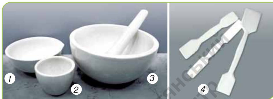
Мал.11. Порцелянове лабораторне обладнання: 1 — чашка для випарювання; 2 — тигель; 3 — ступка з товчачем; 4 — шпателі
