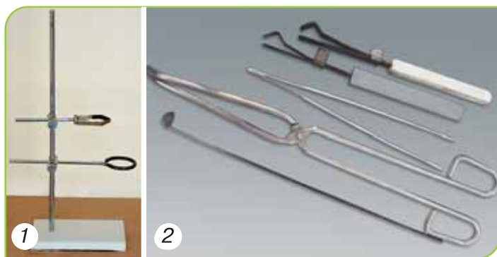
Мал.12. Лабораторне обладнання з металу: 1 — лабораторний штатив; 2 — ручний інструмент (тримачі пробірок, пінцет, затискач, ложка для спалювання речовин)
