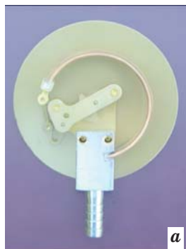
Мал. 23.6. Будова металевого манометра
