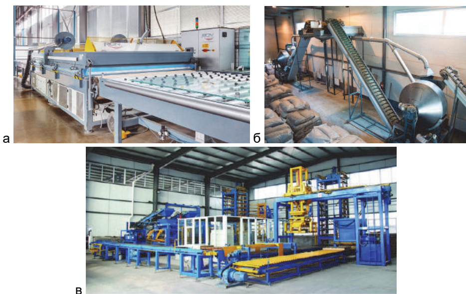
Рис. 2.25. Автоматизовані лінії з виробництва: а) триплексу (багатошарового скла); б) зерноsumішей; в) будматеріалів
