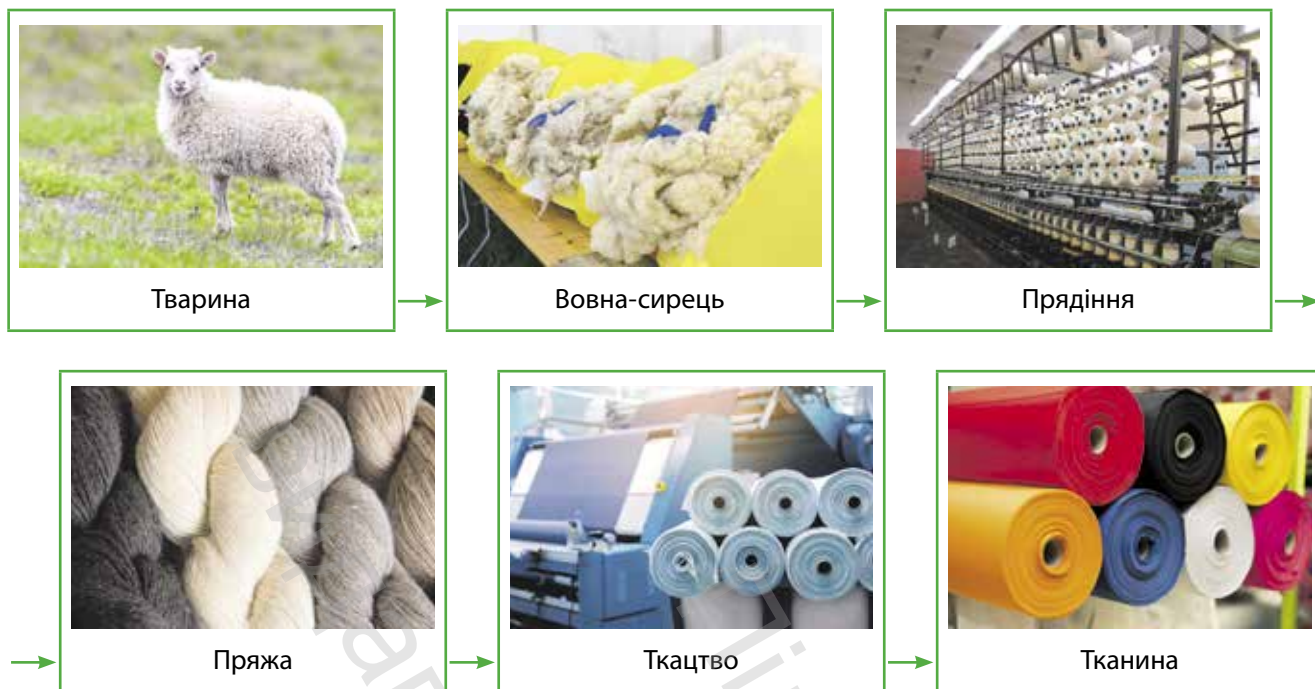
СХЕМА 3. ПРОЦЕС ВИГОТОВЛЕННЯ ТКАНИНИ З ВОВНИ
