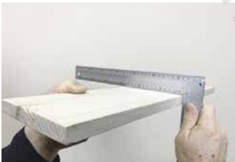
Мал. 6.9. Перевірка стругання площини лінійкою та кутником
