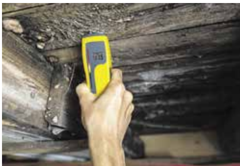
Мал. 4.3. Вимірювання вологості за допомогою вологоміра
