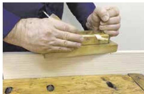
Мал. 6.7. Стругання пластів та крайки
