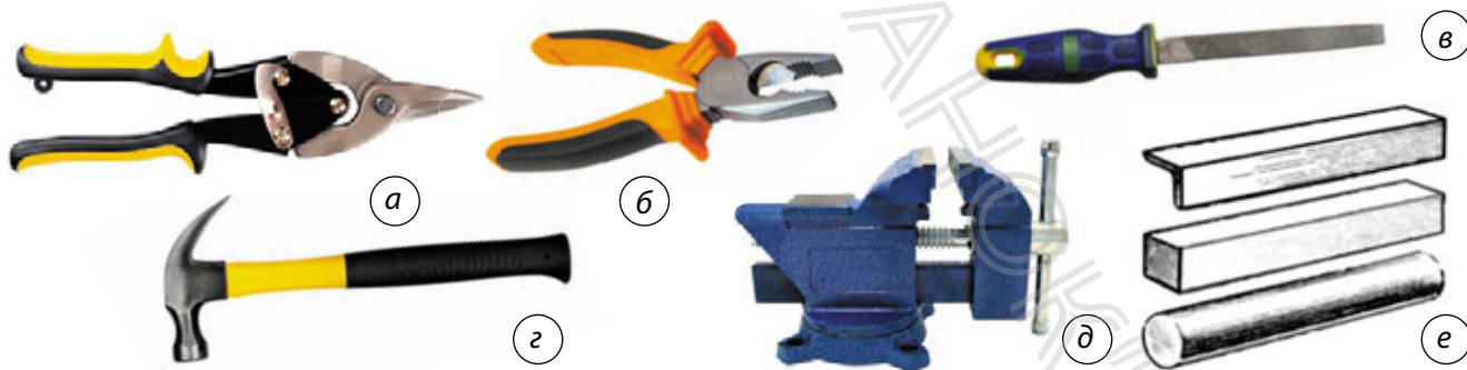
Мал. 15.3. Інструменти та пристосування, необхідні для виготовлення виробів із тонколистового металу: а — ножиці по металу; б — плоскогубці; в — напилек із дрібною насічкою; г — молоток; д — слюсарні лещата; е — оправки
