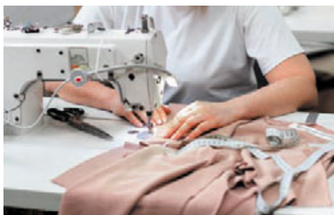
Мал. 17.4. Ліворуч від машинки слід залишати місце, щоб розмістити виріб, який обробляється
