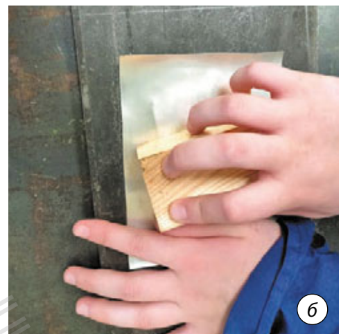
Мал. 15.4. Різні процеси вирівнювання: а — за допомогою киянки; б — за допомогою дерев'яного бруска правилки
