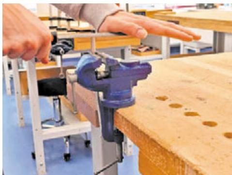
Мал. 15.9. Положення рук під час обпилювання
