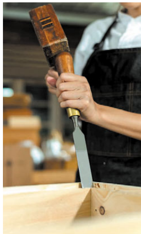
Мал. 18.10. Процес роботи стамескою
