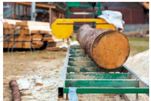
Мал. 4.4. Стрічковий деревообробний верстат
