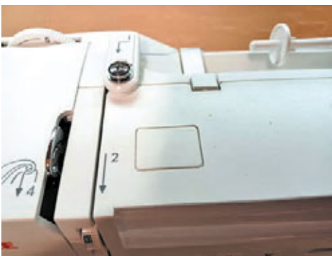
Мал. 17.1. Під час підготовки до роботи швейної машини користуйтеся умовними позначеннями й спеціальними стрілочками
