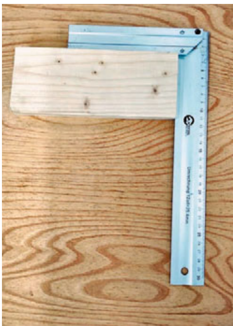
Мал. 18.9. Контроль кута зрізу планки за допомогою столярного кутника
