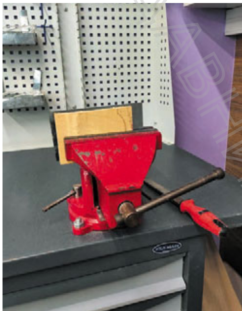
Мал. 15.8. Закріплення заготовки в лещатах під час обпилювання
