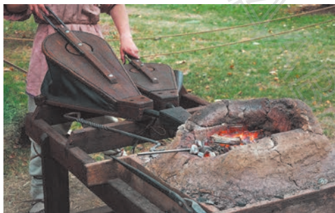
Мал. 38.4. Міхи для нагнітання повітря в полум'я для підвищення його температури
