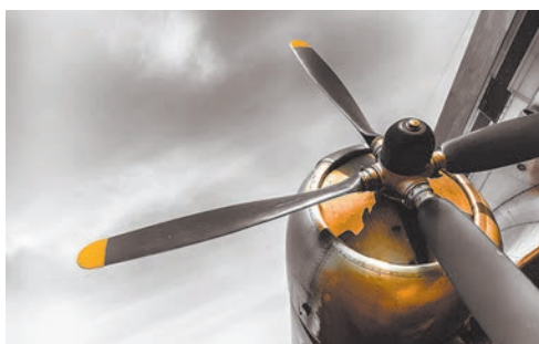
Мал. 15.5. Лопаті пропелера вигнуті так, що попереду них утворюється зона зниженого повітряного тиску, а позаду — підвищеного. Повітря ззаду штовхає пропелер, і літак рухається вперед
