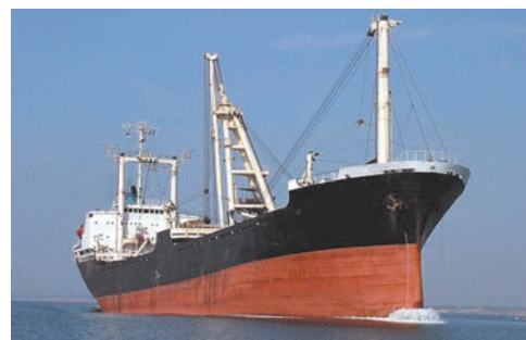
Мал. 5.3. Ватерлінію позначають іззовні корабля контрастними фарбами, щоб її було добре видно
