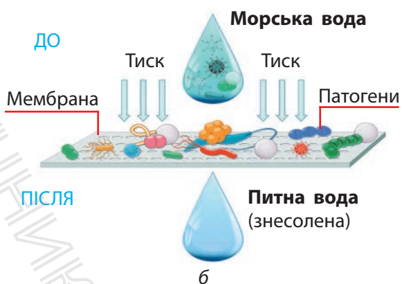
Мал. 2.7. Під час очищення води зворотним осмосом (а) морську воду під великим тиском пропускають крізь мембрану, що затримує частинки солей і хвороботворні бактерії (б)
