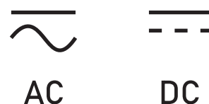
Мал. 18.5. Позначення типу струму буквами та графічними елементами. Буквені позначення походять від англійських термінів: AC — alternating current (змінний струм) та DC — direct current (постійний струм)
