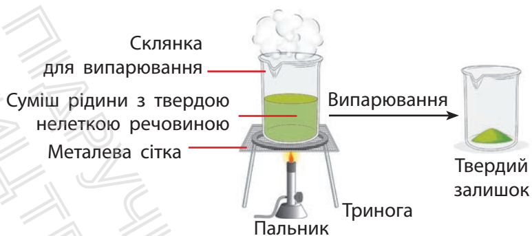
Мал. 2.5. Випарюванням можна відокремити нелетку речовину з розчину
