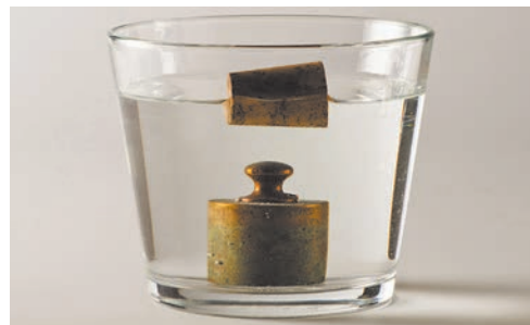
Мал. 4.4. У металевій гирі густина більша, ніж у води, тому вона завжди буде тонути у воді, а в корка 1 густина менша, тож він плаває на поверхні води
