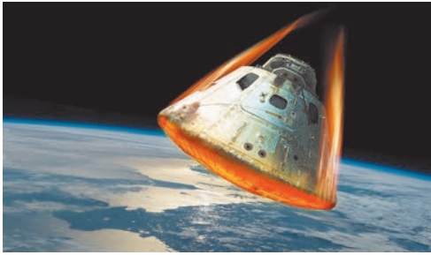
Мал. 37.6. Унаслідок тертя космічного корабля під час посадки на Землю об повітря в щільних шарах атмосфери поверхня корабля дуже розжарюється
