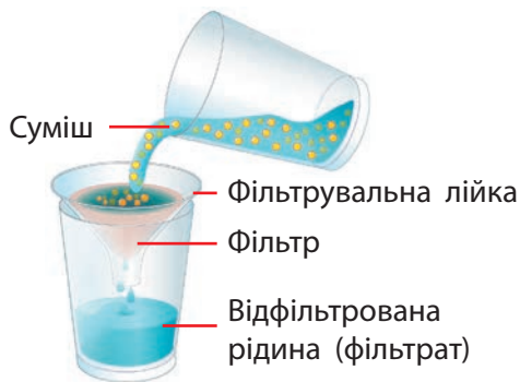
Мал. 2.4. Фільтрування. Вода та розчинені речовини проходять крізь фільтр, а великі часточки — ні
