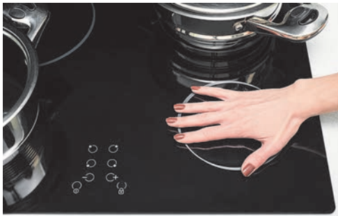
Мал. 21.4. На індукційній печі нагрівається лише дно каструлі та її вміст, а варильна поверхня залишається холодною
