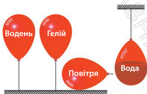
Мал. 15.1. Водень і гелій — гази з густиною меншою, ніж у повітря. Заповнені ними кульки спливають у повітряному океані
