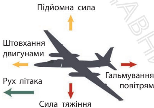
Мал. 15.4. Зліт літака можливий, якщо підйомна сила більша, ніж сила тяжіння до Землі
