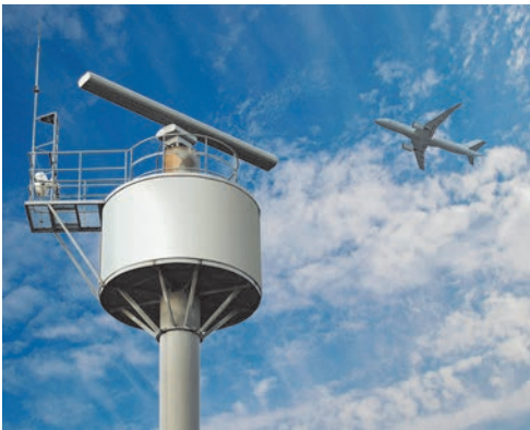
Мал. 36.2. Радіолокаційна станція «спостерігає» за літаками в повітряному просторі, визначаючи відстань до них відлунням радіохвиль
