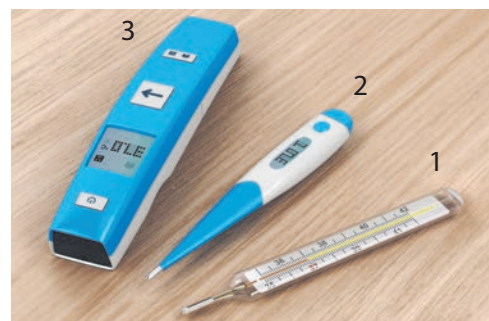
Мал. 25.1. Термометри можуть бути досить різними за принципом дії, проте функція в них одна: вимірювання температури
