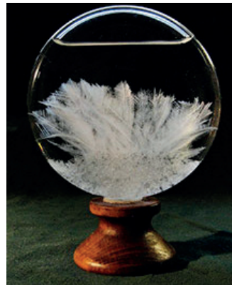
Мал. 101. Барометр Фіцроя (закрита посудина з розчином нашатирного спирту, камфори, калійної селітри)
