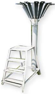
Мал. 148. Спеціальна конструкція для запобігання видуванню опадів
