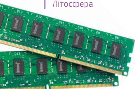
Мал. 86. Позолочені контакти електронних мікросхем
