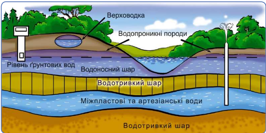
Мал. 178. Схема залягання підземних вод
