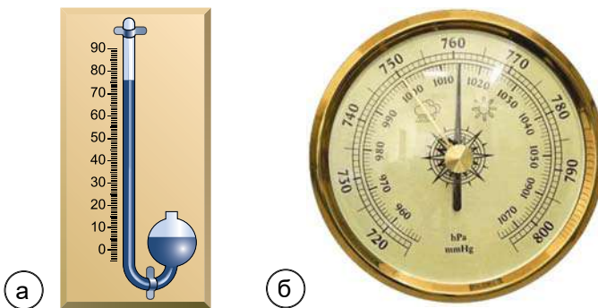
Мал. 98. Барометри: а – ртутний барометр; б – барометр-анероїд
