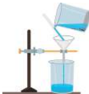
Мал. 19. Розділення суміші води та вугілля фільтруванням
