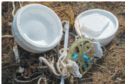
Мал. 21.2. Метеозонд у розібраному вигляді
