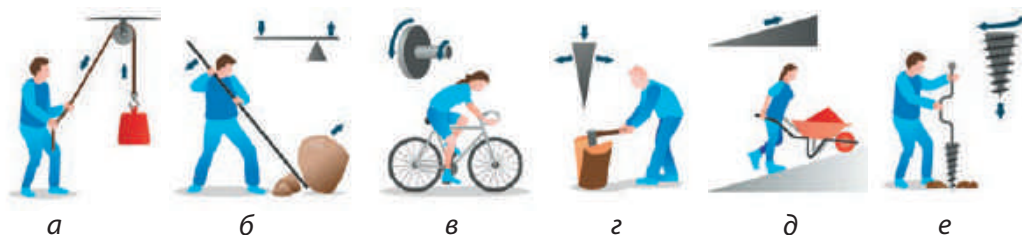
Мал. 17.4. Приклади простих механізмів: блок (а), важіль (б), коловорот (в), клин (г), похила площина (д), гвинт (е)
