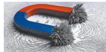
Мал. 23.2. Силові лінії магнітного поля навколо магніту (а) можна виявити залізним порошком (б)
