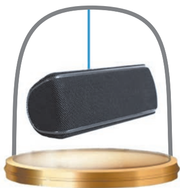
Мал. 42.1. Звук від колонки не поширюється в безповітряному середовищі
