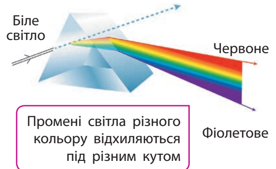
Мал. 14.1. Розділення білого світла на різні промені під час проходження крізь призму
