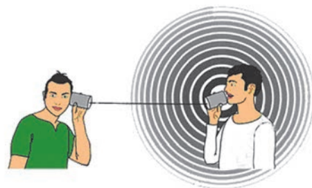
Звук поширюється у твердій речовині (ниткою між стаканами)
