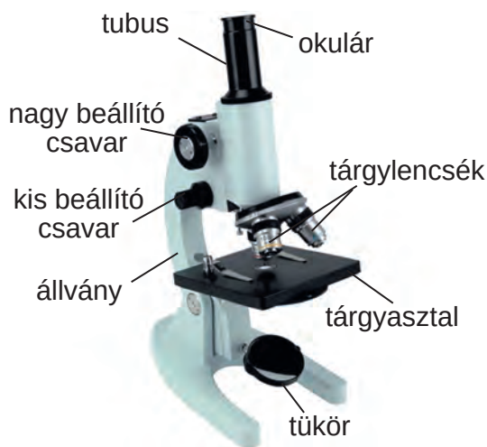
151. ábra. A mikroszkóp szerkezete
