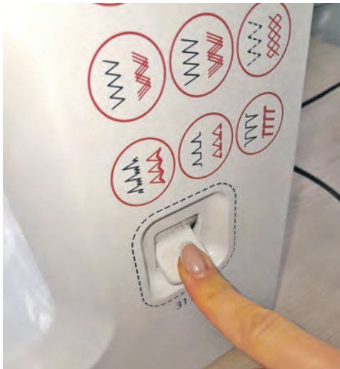
10.25. ábra. A sor elején és végén készítsünk rögzítő öltéseket
