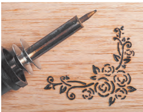
9.16. ábra. Elektromos égető és a vele végzett faégetési munka
