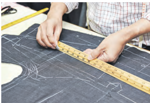
10.14. ábra. A szabásminták kontúrozásához használhatunk a szabókrétát
