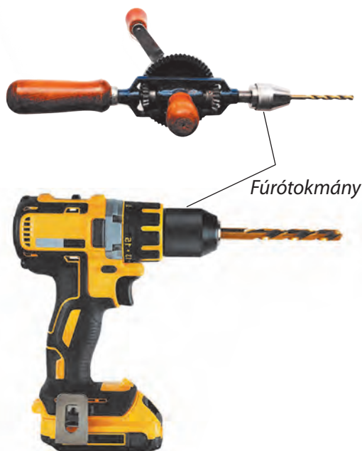
9.10. ábra. A fúró rögzítése a fúrótokmányban (szorítóhüvelyben)
