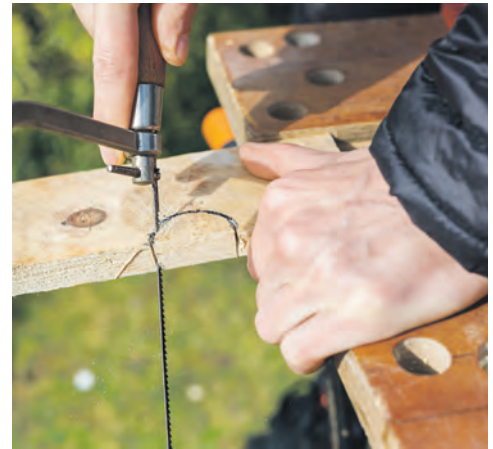
9.8. ábra. Fűrészelés a külső kontúr mentén
