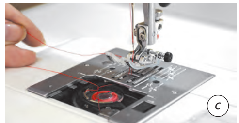
10.23. ábra. Az alsó cérna befűzése egy vízszintes orsószerkezetű géphez
