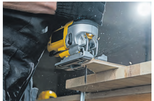
9.20. ábra. A fűrész nem forgatják el, nem döntik meg. Fel-le kell mozognia.
