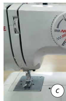
10.20. ábra. Különböző meghajtású varrógépek: a — kézi; b — lábitós; c — elektromos
