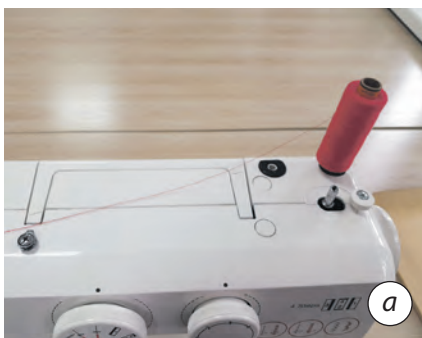
10.21. ábra. A felső cérná befűzése a gépbe
