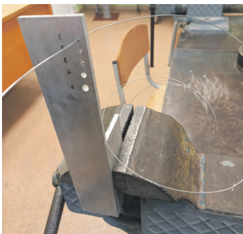
12.3. ábra. A huzal kiegyenesítésének folyamata
