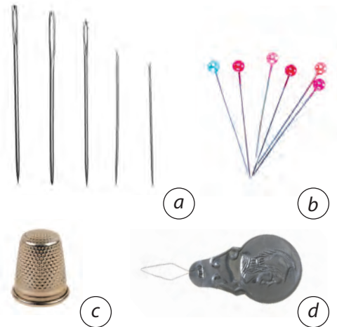
10.6. ábra. Eszközök kézi varráshoz: a — kézi varrotűk; b — gombostűk; c — gyűszű; d — cérnahúzó
