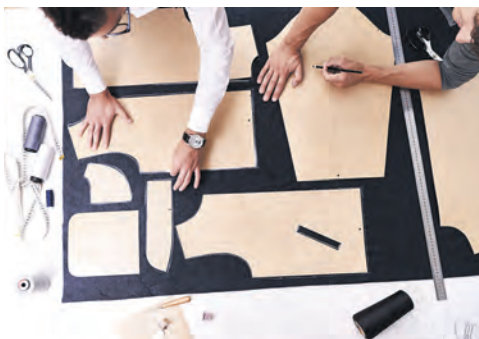
10.13. ábra. A termék minden alkatrészét jelölő szabás minta fontos
