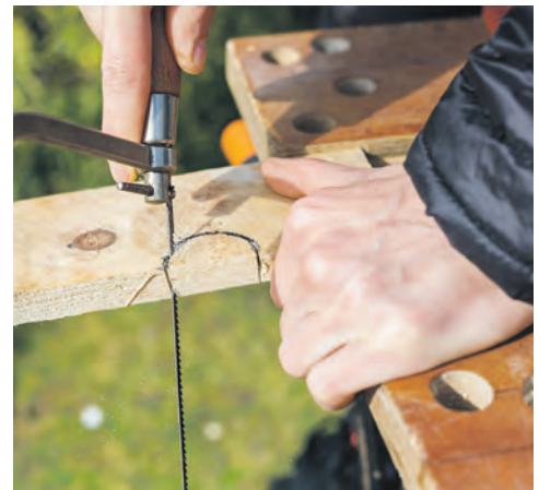
Fig. 9.8. Tăierea de-a lungul conturului exterior
