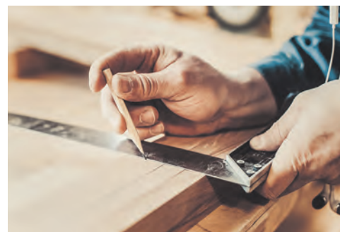
Fig.7.2. Este mai bine să aplicați linii de marcare cu o riglă și puteți marca atât lemnul, cât și materialul
