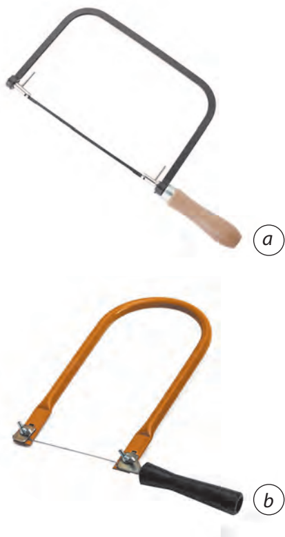
Fig.9.6. Ferăstrău manual: a — cu ramă plată; b — cu ramă tubulară
