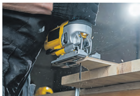
Fig.9.20. Ferăstrăul nu este rotit sau înclinat. El trebuie să se miște în sus și în jos
