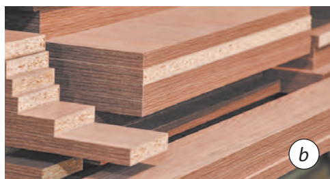
Fig.9.1. Diferite tipuri de materiale lemnoase: a — placaj; b — PAL din lemn
