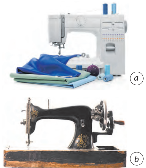
Fig. 4.2. Mecanisme de antrenare ale mașinii de cusut: a — mașină de cusut electrică; b — mașină de cusut cu acționare manuală
