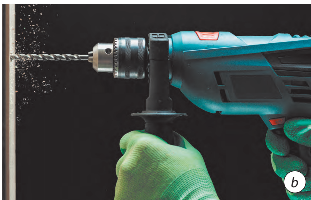
Fig.9.12. Poziția burghiului în timpul funcționării
