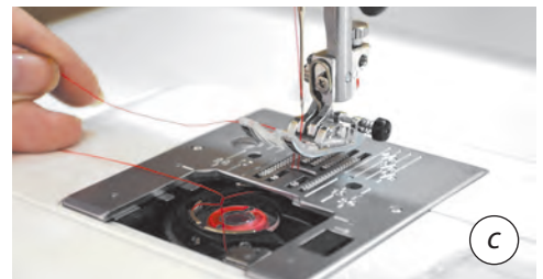
Fig. 10.23. Infilarea firului interior într-o mașină cu mecanism de navetă orizontal
