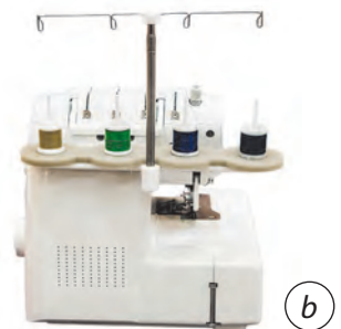
Fig. 10.7. Echipamente pentru prelucrarea la mașină a țesăturilor: a — mașină de cusut; b — overlock
