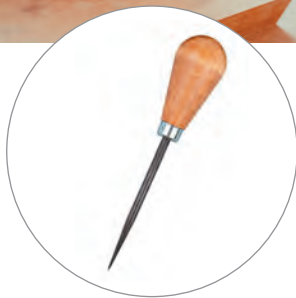
Fig. 9.18. Înainte de a tăia, ar trebui să perforați toate găurile cu o sulă
