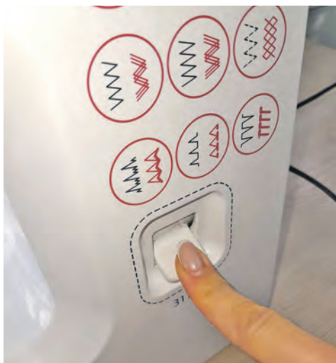
Rys. 10.25. Na początku i na końcu wykonywać mocowanie
