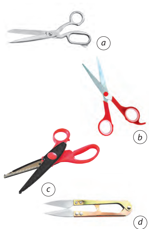
Rys. 10.5. Nożyczki: a — krawieckie; b — do papieru; c — z ostrzami ząbkowanymi; d — do obcinania nitek
