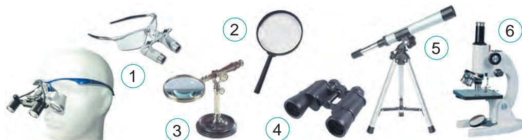
Imag. 20. Dispozitive de măsurare: 1 — lupă binoculară; 2 — lupă; 3 — lupă cu stativ; 4 — binoclu; 5 — telescop școlar; 6 — microscop
