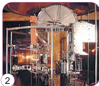
Imag. 58. Etaloanele masei: 1 — fostul etalon al masei de 1 kg; 2 — dispozitiv modern pentru determinarea etalonului masei — cântarul Kibble; 3 — „etalonul” tău casnic de masă
