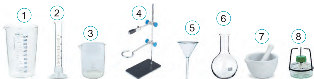
Imag. 21. Utilaje de laborator: 1 — pahar gradat; 2 — cilindru gradat; 3 — pahar; 4 — stativ; 5 — pâlnie; 6 — retortă; 7 — piuliță cu pisălog; 8 — arzător cu alcool
