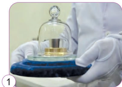
Imag. 58. Etaloanele masei: 1 — fostul etalon al masei de 1 kg; 2 — dispozitiv modern pentru determinarea etalonului masei — cântarul Kibble; 3 — „etalonul” tău casnic de masă
