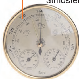
Barometr aneroid (aneroidowy) – mierzy ciśnienie atmosferyczne
