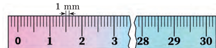
Rys. 22. Wartość podziałki oraz granica pomiaru linijki
