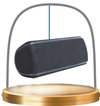
42.1. ábra. A hangszóróból származó hang légüres környezetben nem terjed
