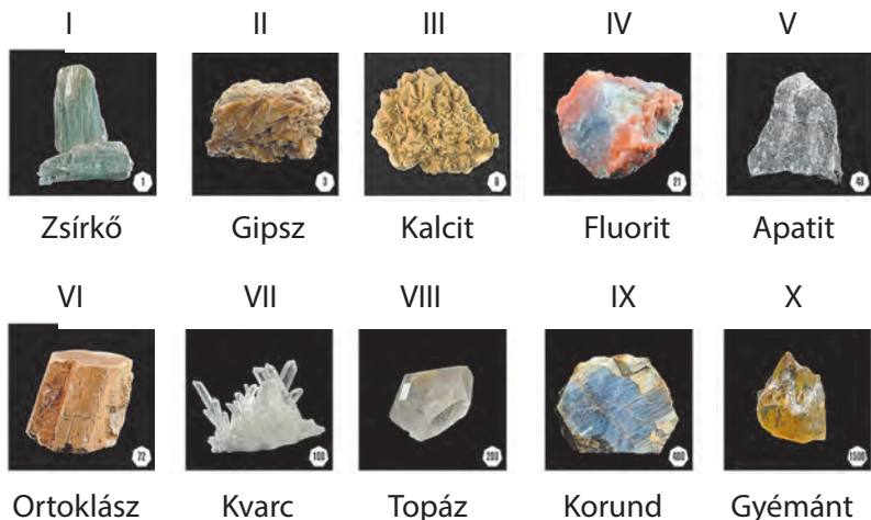
39.4. ábra. A Mohs-skála (a római számok az ásványok keménységét jelölik ezen a skálán)
