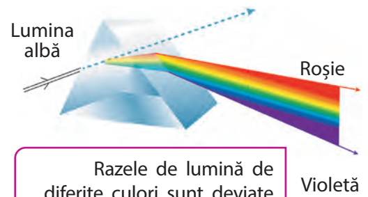
Fig. 14.1. Separarea luminii albe în diferite raze atunci când trece printr-o prismă
