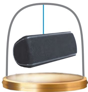
Fig. 42.1. Sunetul din difuzor nu se propagă într-un mediu fără aer
