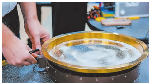
Fig. 42.4. Pe sursa de sunet (difuzor) este plasat un bazin metallic cu nisip alb. Vibrațiile sonore de la difuzor sunt transmise nisipului, iar noi „vedem” sunetul
