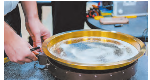
Rys. 42.4. Metalowa miska z białym piaskiem postawiona na źródle dźwięku (głośnik). Drgania dźwiękowe z głośnika przenoszą się do piasku, co pozwala „zobaczyć” dźwięk
