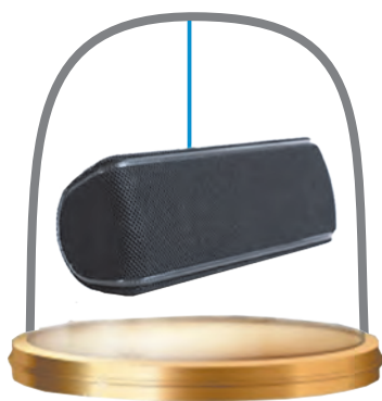
Rys. 42.1. Dźwięk z głośnika nie rozprzestrzenia się w środowisku pozbawionym powietrza
