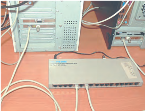
2.4. ábra. Számítógépek összekötése kommunikációs eszközzel vezeték technológiával
