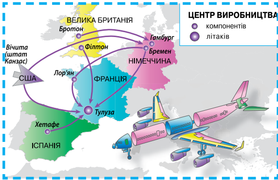
Мал. 26. Схема кооперації з виробництва літаків «Аеробус»
