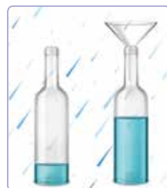
141. ábra. A teleszkóp nagyobb objektívje több fényt gyűjt össze
