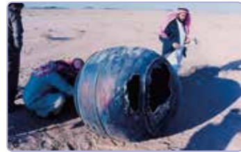
172. ábra. A PH Delta hordozó 3. fokozatának közel 70 kg tömegű motorborítása, mely Rijád városától 240 km-re zuhant le (2001, Szaúd-Arábia)
