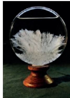
Ryc. 92. Barometr Fitzroy (zamknięte naczynie z roztworem amoniaku, kamfory, potasowej saletry)
