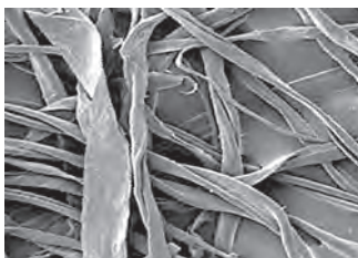
Бавовняне волокно під електронним мікроскопом
