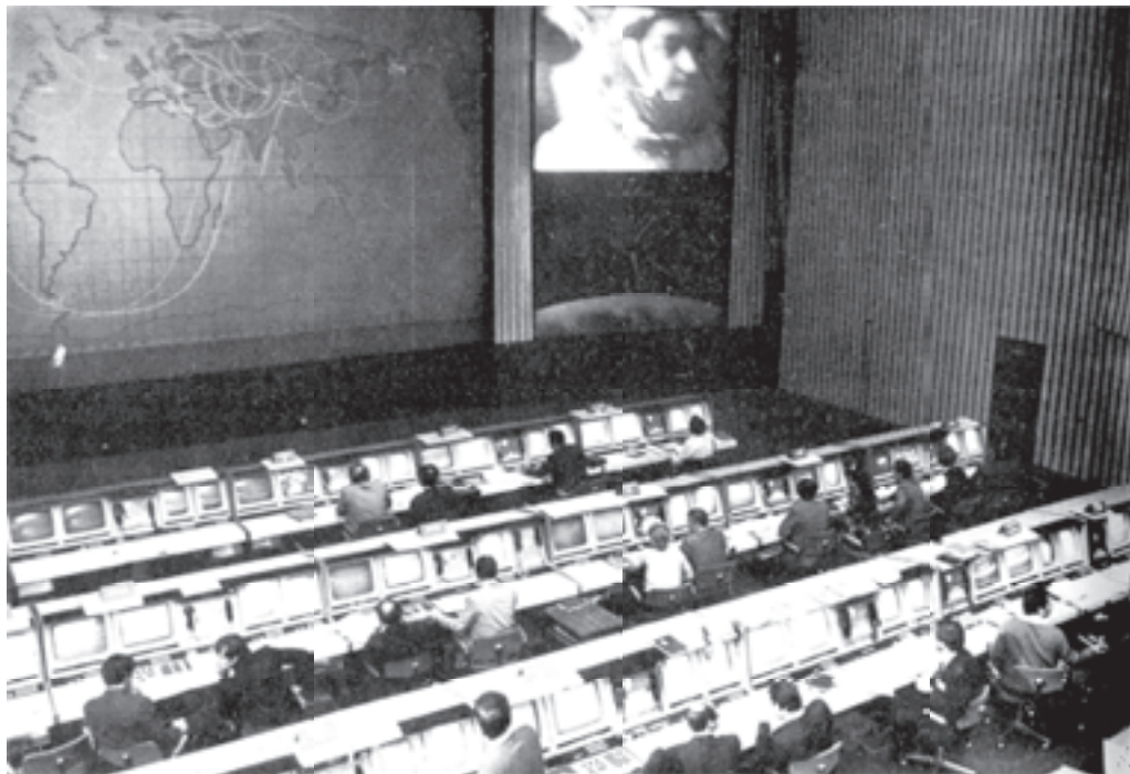
1.8. ábra. A repülésirányítási központban lévő Dnyipro számítógéphez több tucat felhasználó csatlakozhatott egyidejűleg
