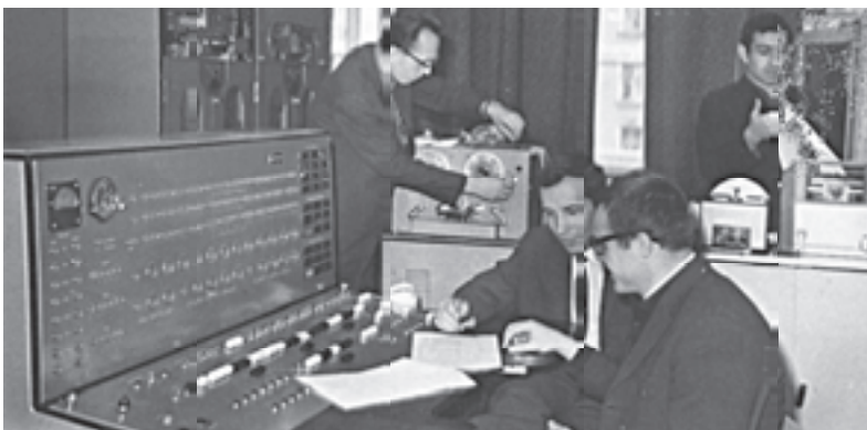
1.7. ábra. A Minszk számítógép vezérlőegysége, kiviteli- és beviteli eszközei
