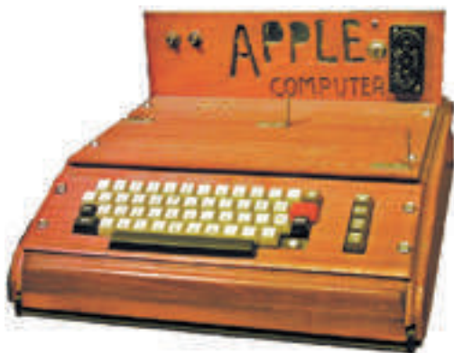
Fig. 1.9. Unul din primele calculatoare ale corporației APPLE încă nu avea monitor personal și se conecta la televizor
