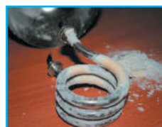
Usuwanie osadu z kamienia
