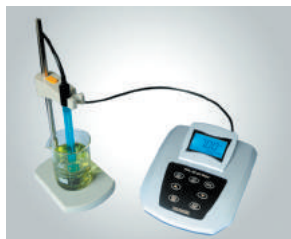
Rys. 11.4. Do mierzenia pH wykorzystuje się specjalne urządzenia – pH-metry: a – laboratoryjny (stacjonarny); b – przenośny
