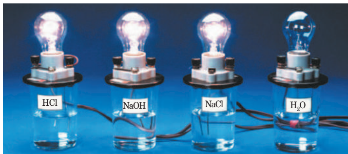
Rys. 8.1. Roztwory kwasu, zasady i soli przewodzą prąd elektryczny, a czysta woda – nie
