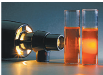
Rys. 3.7. Efekt (zjawisko) Tyndalla: podczas przepuszczania światła przez roztwór rzeczywisty promień nie rozprasza się, w odróżnieniu od przechodzenia przez roztwór koloidalny
