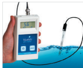
Rys. 11.4. Do mierzenia pH wykorzystuje się specjalne urządzenia – pH-metry: a – laboratoryjny (stacjonarny); b – przenośny
