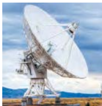
Rys. 21.3. Promieniowanie wąskiej skierowanej wiązki ultrakrótkich fal radiowych i odbieranie odbitego sygnału zabezpiecza paraboliczna antena radaru
