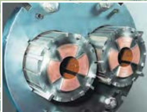
Rys. 2. Potężne magnesy, utrzymujące cząstki naładowane w środku akceleratora
