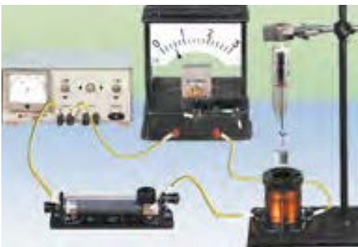
Rys. 6.1. Badanie działania magnetycznego zwojnicy z prądem
