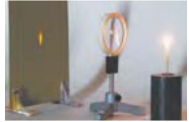
Rys. 15.1. Otrzymywanie obrazu płomienia świecy za pomocą soczewki skupiającej
