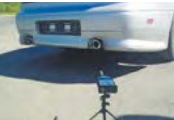
Rys. 5. Mierzenie poziomu hałasu tłumika samochodu
