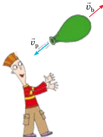
Rys. 37.1. Ruch balonika pod działaniem powietrza, które wydostaje się z otworu, jest to ruch odrzutowy
