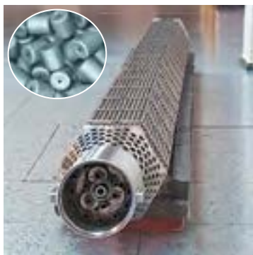
Rys. 27.1. Pręty paliwowe – część reaktora, urządzenie, które zawiera paliwo jądrowe (Uran)
