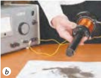
Rys. 6.4. Gdy obwód zamkniemy, wiórki żelazne przyciągną się do rdzenia (a); po rozerwaniu – odpadną (b)
