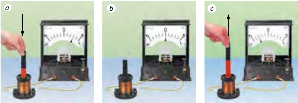
Rys. 8.1. Doświadczenia potwierdzające powstanie prądu: a – magnes wsuwamy do zwojnicy, wskazówka galwanometru odchyła się w prawo; b – magnes nieruchomy, prądu nie ma, wskazówka nie odchyła się; c – przy wysuwaniu magnesu ze zwojnicy, wskazówka galwanometru odchyła się w lewo
