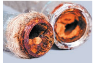
Результати життєдіяльності залізобактерій у водогонних трубах
