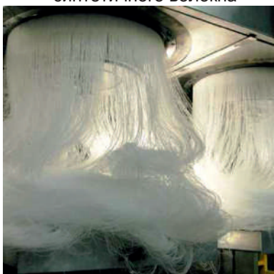
Мал. 1.2. Формування волокна з подальшим витягуванням
