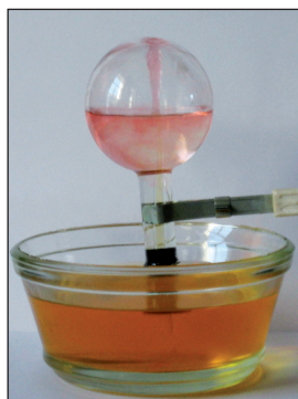
42. ábra A hidrogén-klorid oldódása vízben (szökőkút-kísélet)
