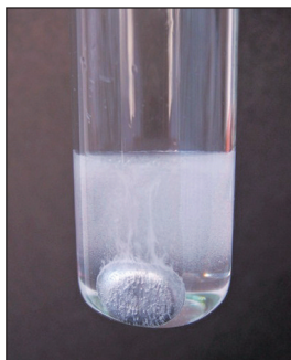
65. ábra Alumínium reak- ciója lúgoldattal
