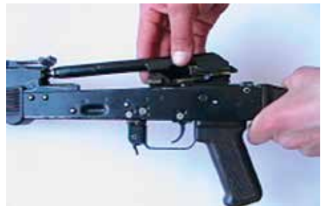
• Від'єднання затворної рами з затвором
