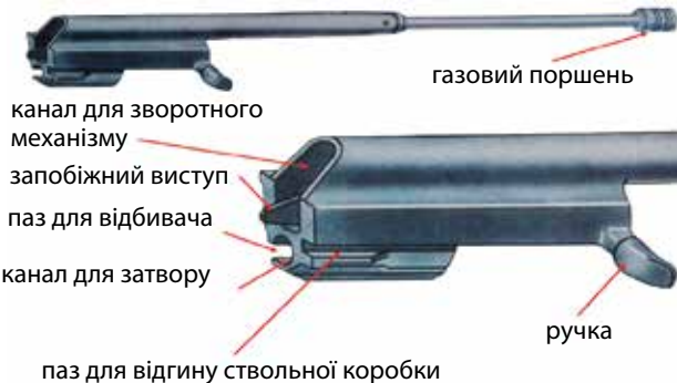
• Затворна рама з газовим поршнем
