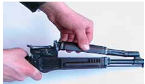
• Від'єднання газової трубки зі ствольною накладкою
