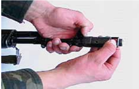
• Від'єднання від автомата дульного гальмо-компенсатора
